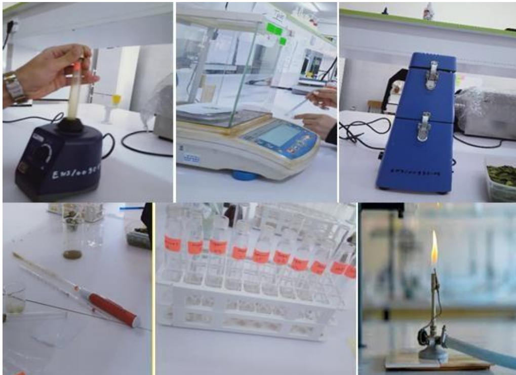
Figure 32 : Matériel utilisé : Vortex, Balance, Broyeur, pipete, Tubes à essai, Bec benzène (par ordre de gauche à droite) (04/02/2024).
