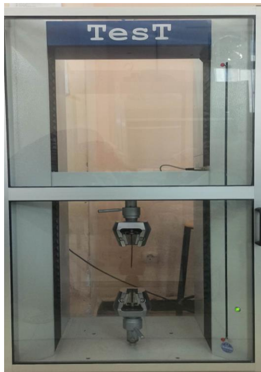
Figure III.10 : Vue d'ensemble de la machine de traction Test GmbH.
