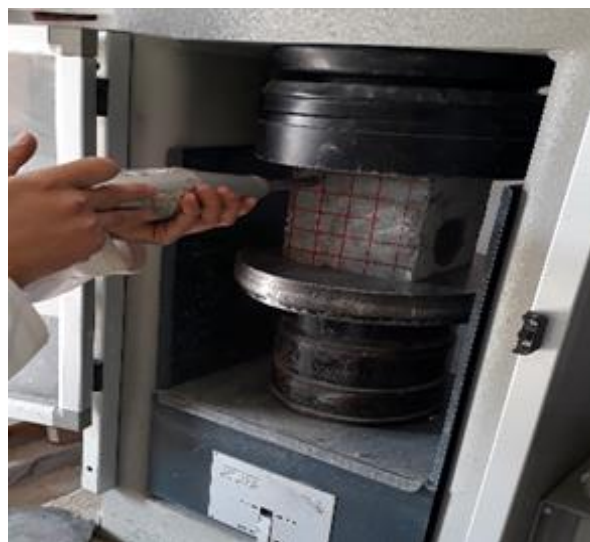
Figure III. 8: Essai au scléromètre
