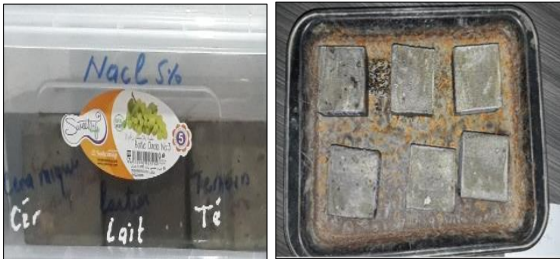
Figure III. 13: Essai pénétration des chlorures
