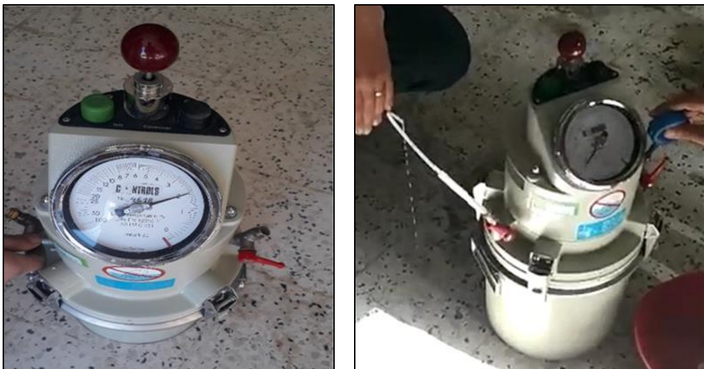
Figure III. 4: Aéromètre à béton
