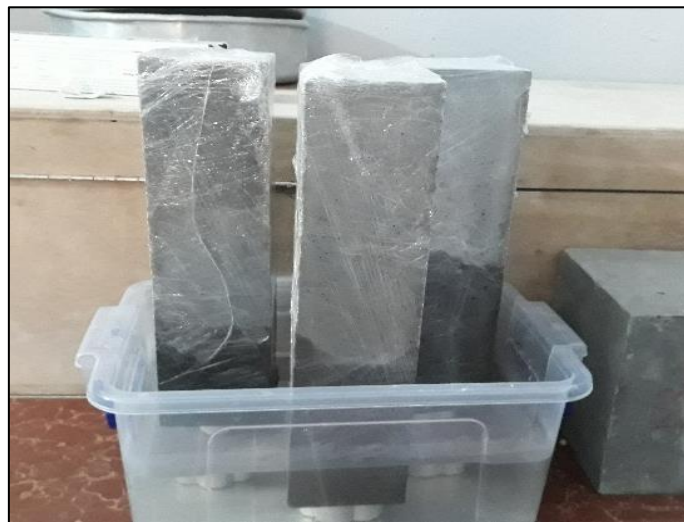
Figure III. 12: Essai d'absorption par capillarité
