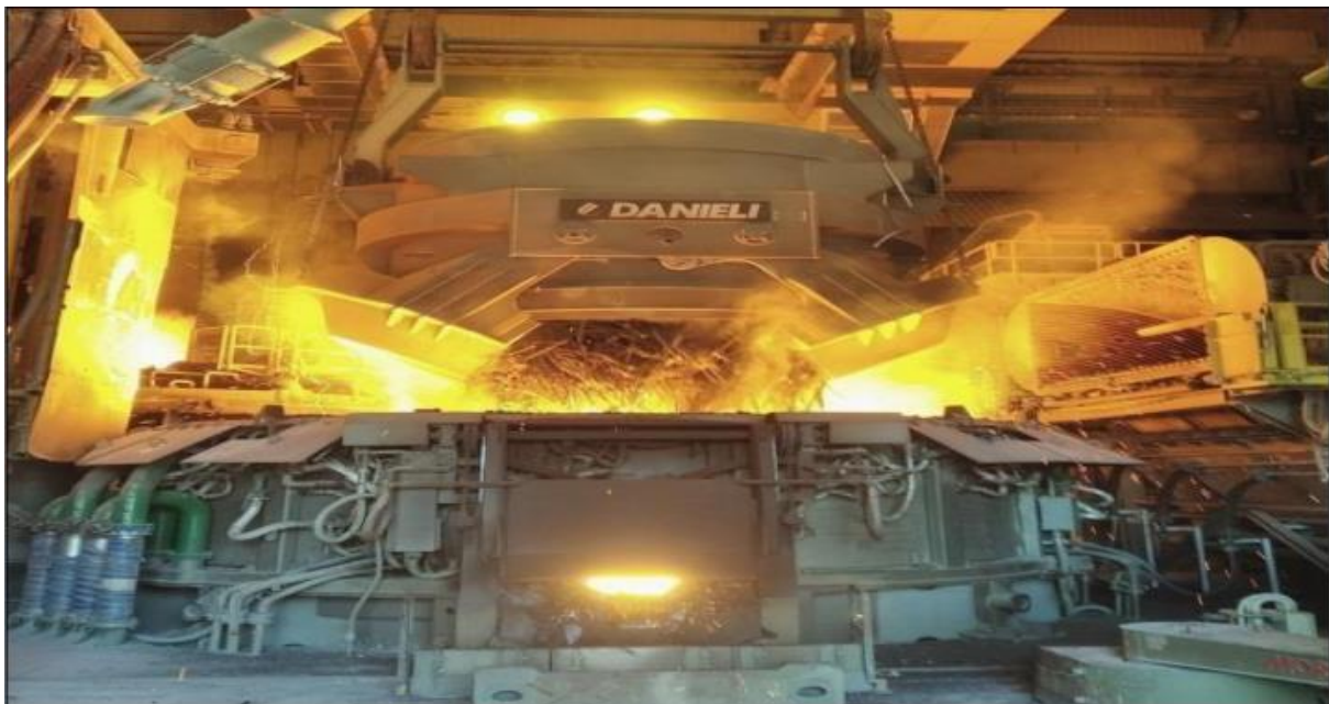
Figure 3.21. Chargement de la ferraille dans le four. [44]
