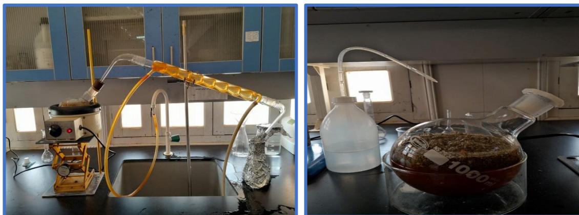
Figure 9. Dispositif d'hydro distillateur de type Clevenger (à gauche) et préparation du matériel végétal dans le ballon en verre pour l'extraction de l'huile essentielle (à droite)
