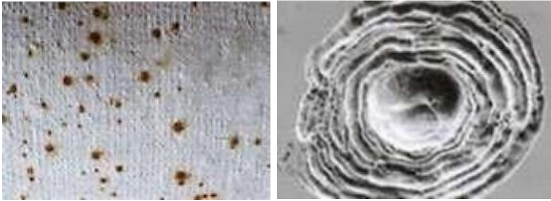
Figure I. 4 : Corrosion par piqûres.
