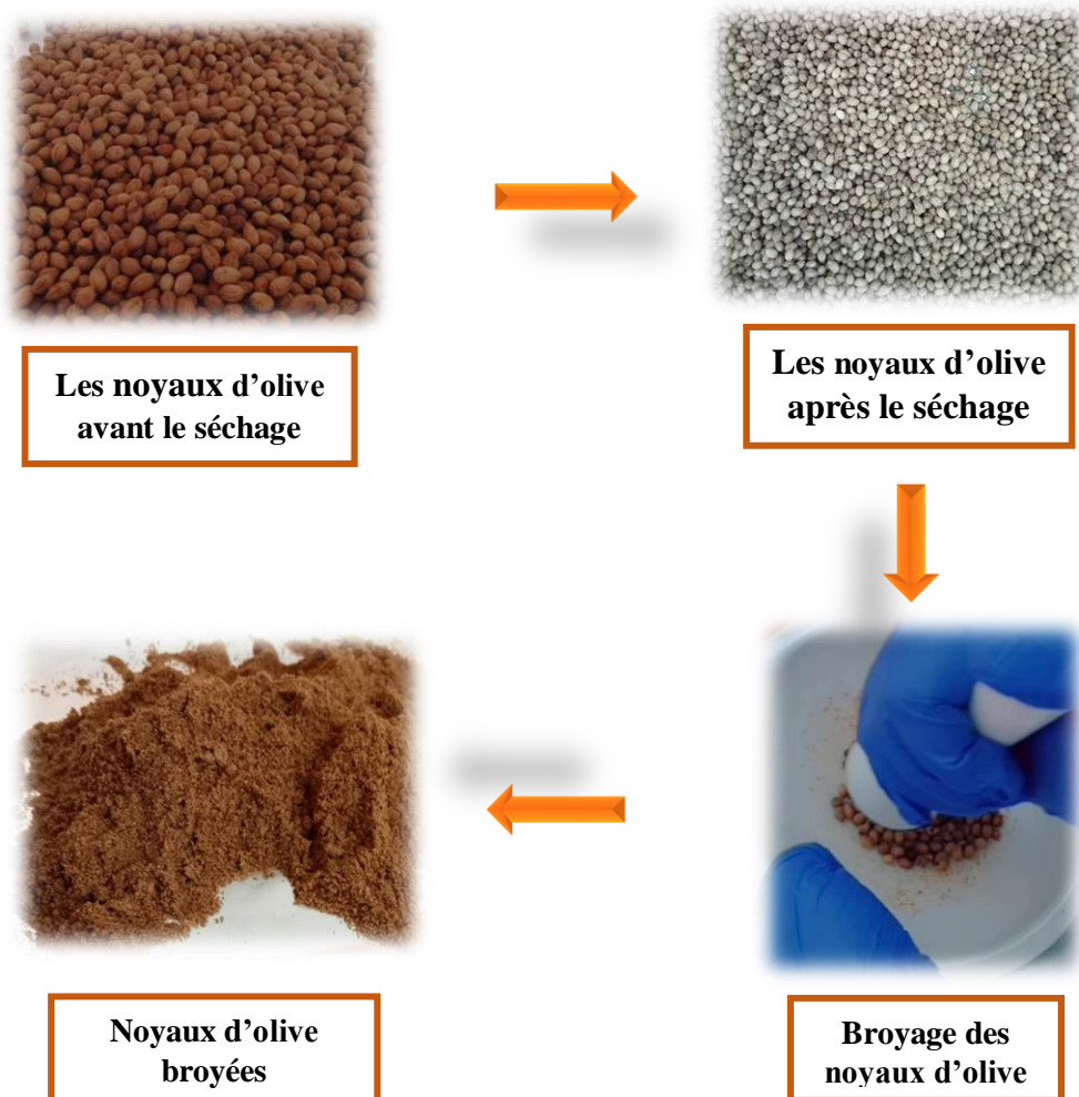
Figure III.10 : Schéma représente les étapes de préparation de la poudre des noyaux d'olive
