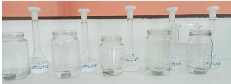
Figure III.15 : méthode de perte de masse (Immersion l'acier1020 dans solutions corrosifs HCl (1% ,2% ,3% ,4% ,5% en absence des différentes concentrations de l'inhibiteur à la température ambiante) .
