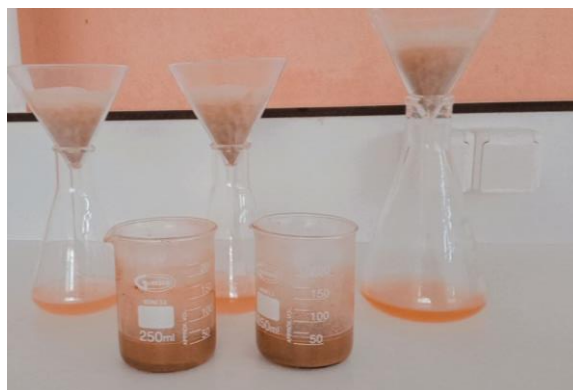
Figure III.13 : Montage de filtration de solution.
