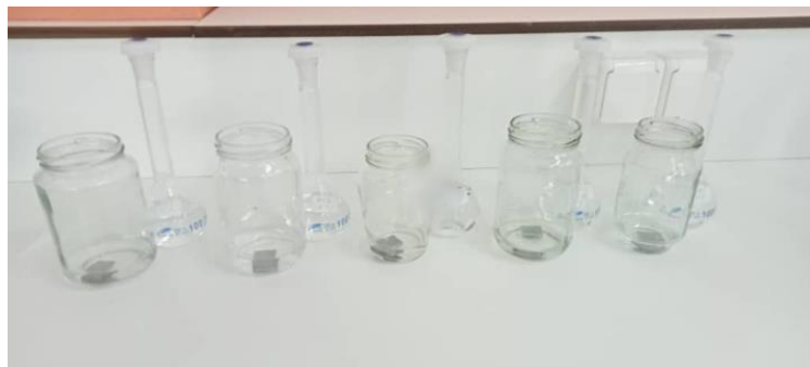
Figure III.16 : méthode de perte de masse (Immersion l'acier1020 dans solutions corrosifs H 2 SO 4 (1% ,2% ,3% ,4% ,5% en absence des différentes concentrations de l'inhibiteur à la température ambiante) .
