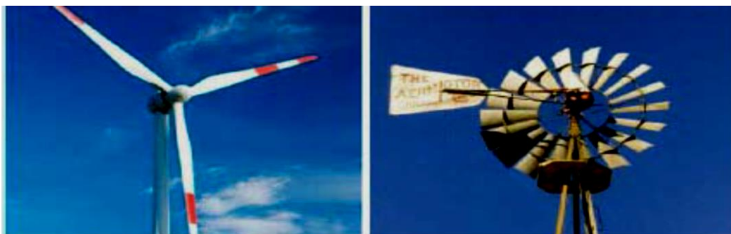
Figure I.7 éoliennes à axe horizontale tripale et multi-pale [17]
