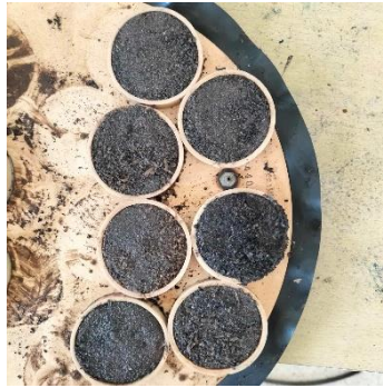
Figure 17. Les échantillons utilisés pour mesurer la capacité de rétention d'eau.
