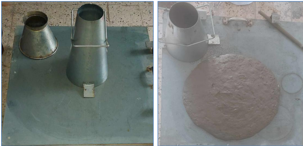
Figure III.8: Affaissement au cône d'Abrams
