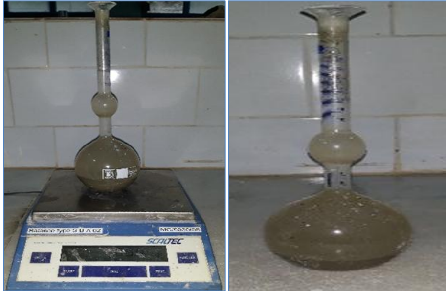
Figure II.2: Mesure de la densité du ciment
