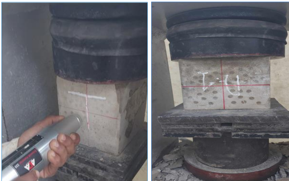
Figure III.12: Essai au scléromètre
