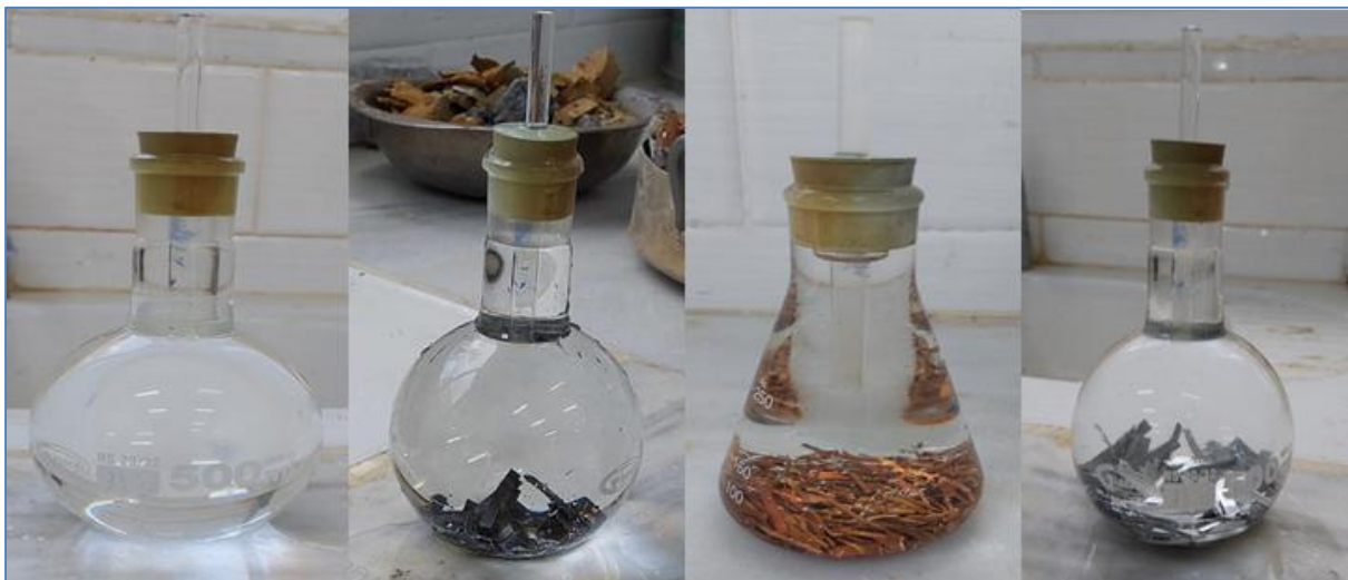
Figure II.10: Mesure de la densité ses fibres
