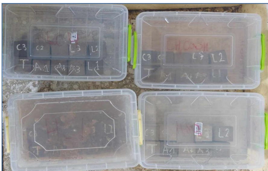
Figure III.18: Conservation des éprouvettes dans les solutions
