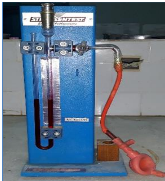
Figure II.3: Mesure de la finesse du ciment
