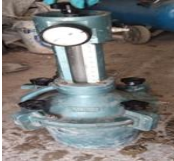
Figure I.3: Aéromètre a béton
