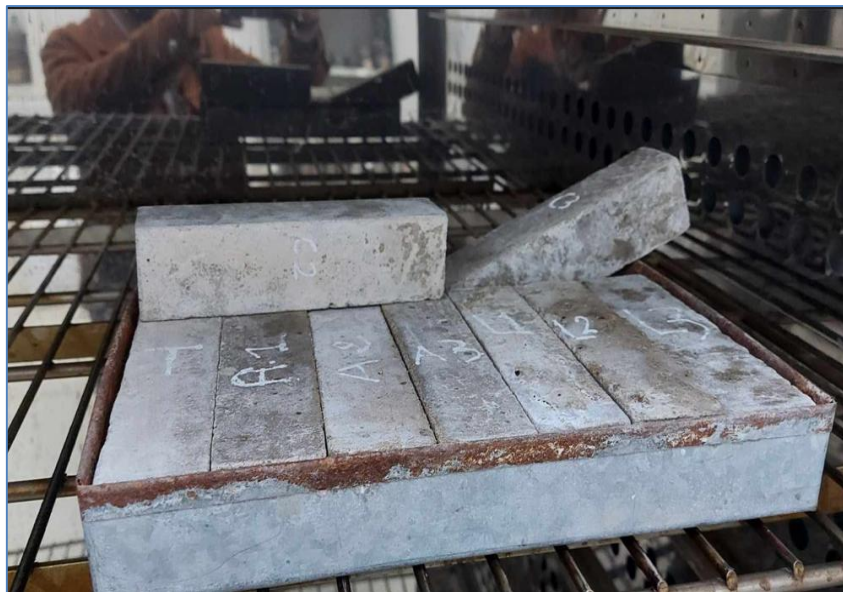
Figure III.14: Essai d'absorption d'eau par immersion
