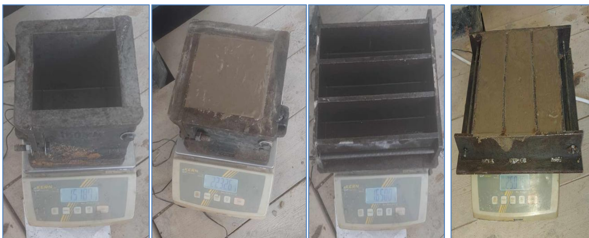
Figure III.7: Mesure de la densité du béton frais
