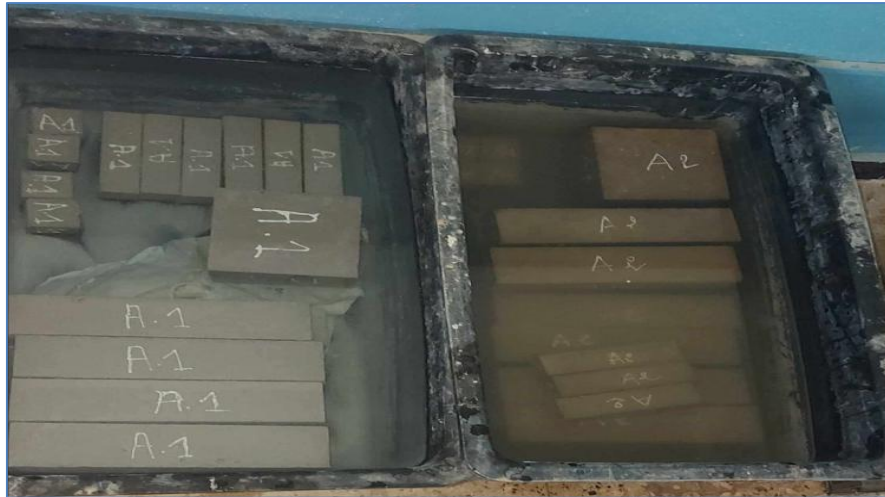
Figure III.6: Conservation des éprouvettes après décoffrage
