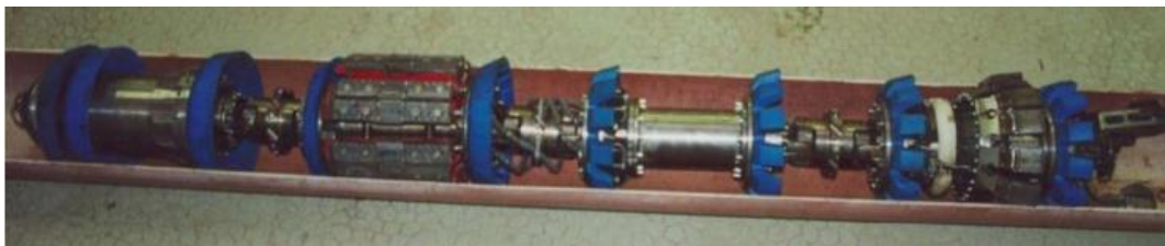
Figure I. 7. Piston instrumenté pour l'inspection des gazoducs [16].
