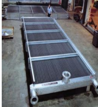
Figure II.4 : Faisceaux d'a ror frig rant en construction [12]
