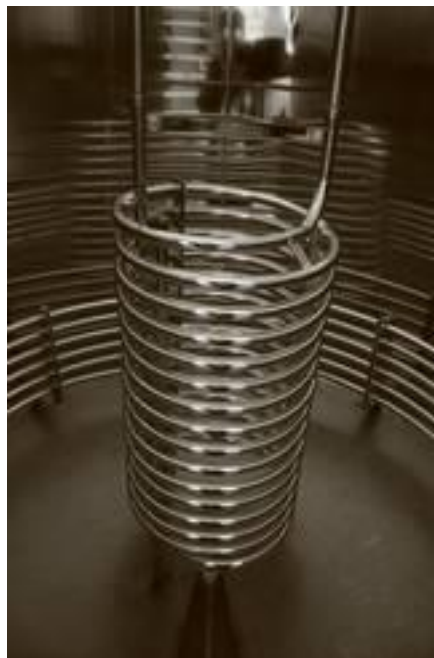
Figure I.5 : L'échangeur thermique en forme de serpent
