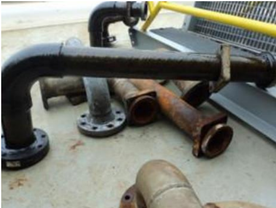
Figure. I.10. L'influence du phénomène d'électrolyte conducteur sur les tuyaux en acier.
