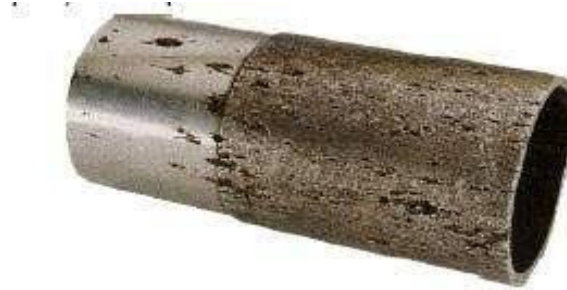
Figure. I.11. Corrosion par piqûre d'un l'acier inoxydable.
