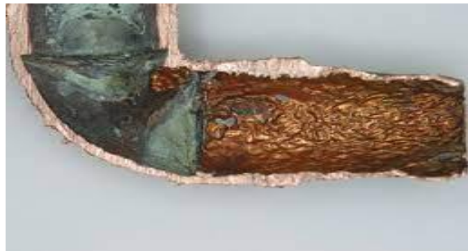
Figure. I.7. Corrosion par érosion.
