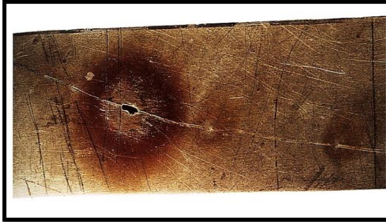
Figure. I.4. Corrosion par piqures sur la paroi d'une cuve en acier Inoxydable.
