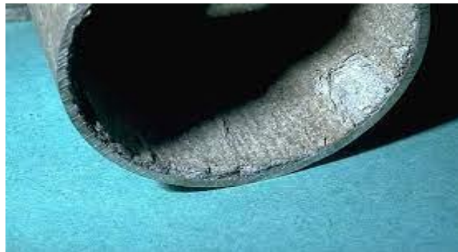
Figure. I.12. Corrosion intergranulaire d'un l'acier inoxydable.
