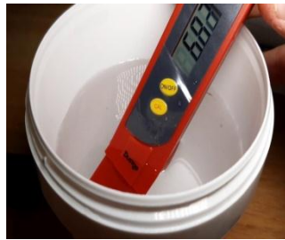
Figure III.11. 6 : TDS mètre testeur de qualité de l'eau
