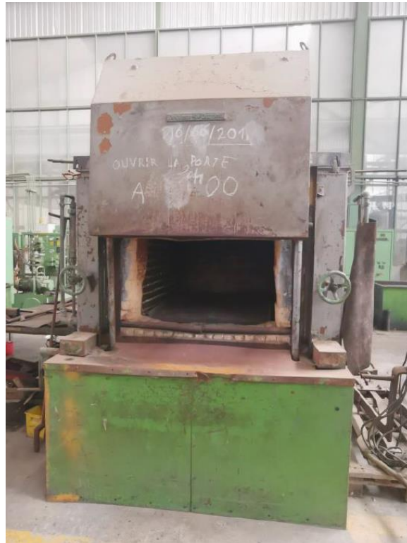
Figure 23 : Four industriel de recuit de l'entreprise ENMTP
