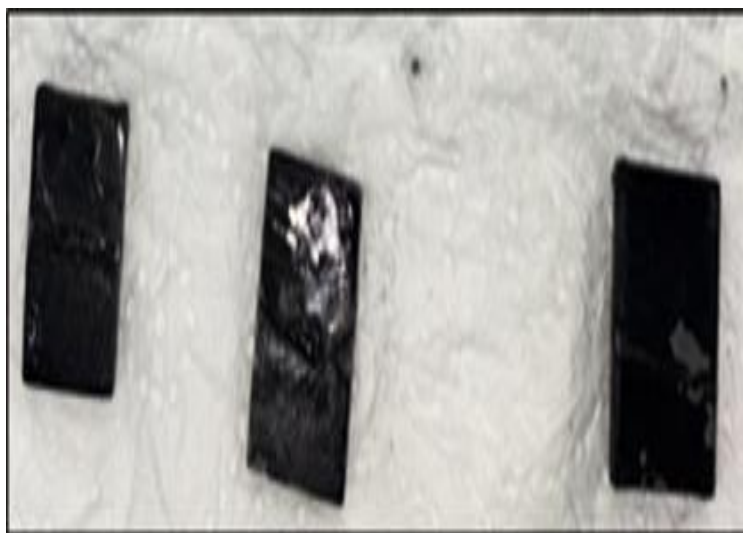
Figure III.17: L'échantillon après 5h dans la solution de H_2SO_4 .
