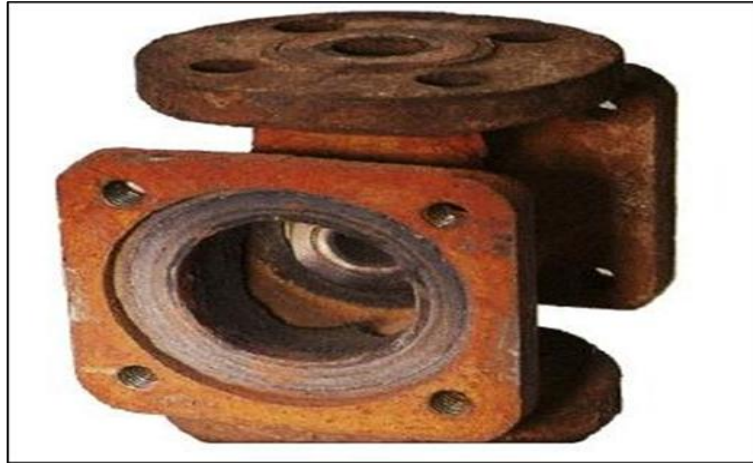
Figure I.4 : Corrosion générale (rouille) d'une pièce en acier [6].
