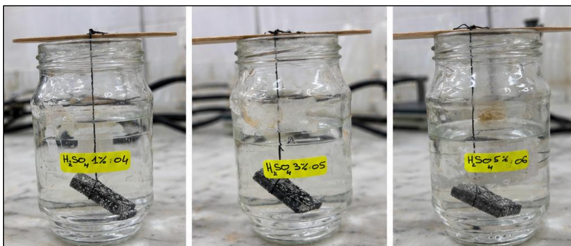
Figure III.9 : Immersion des échantillons sans peinture dans la solution de H_2SO_4 .
