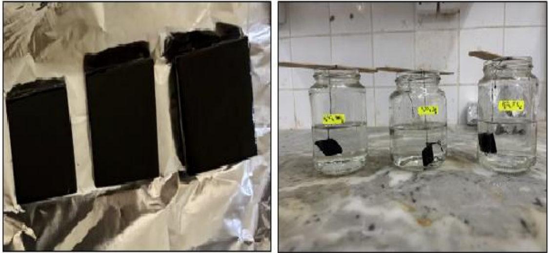
Figure III.20 : Immersion des échantillons avec deux couches de peinture dans la solution de H_2SO_4 .
