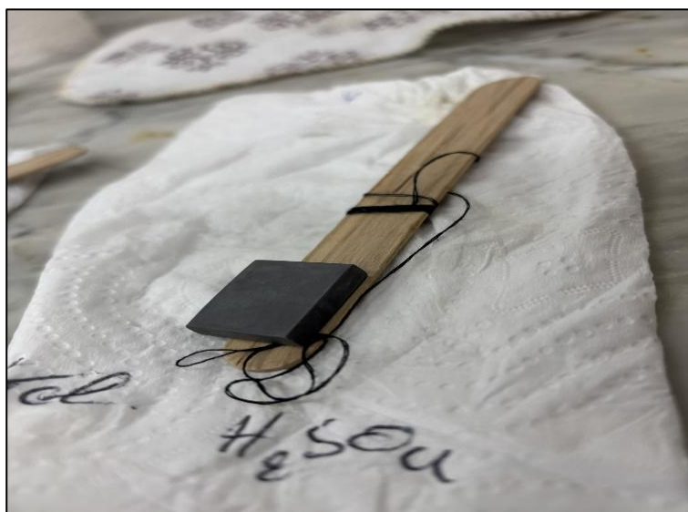
Figure III.10 : L'échantillon après 5h dans la solution de H_2SO_4 .
