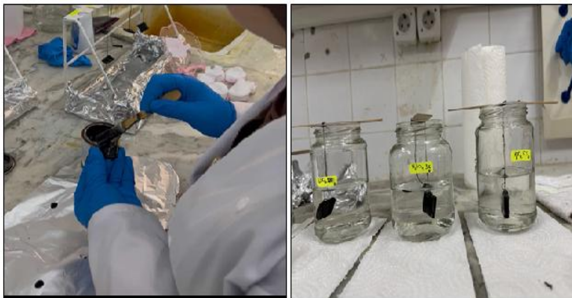
Figure III.16 : Immersion des échantillons avec couche de peinture dans la solution de H_2SO_4 .
