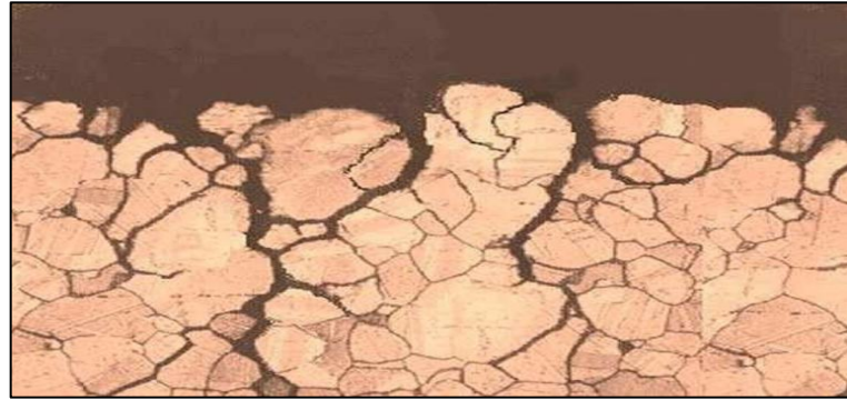
Figure I.7 : Corrosion inter granulaire [10].
