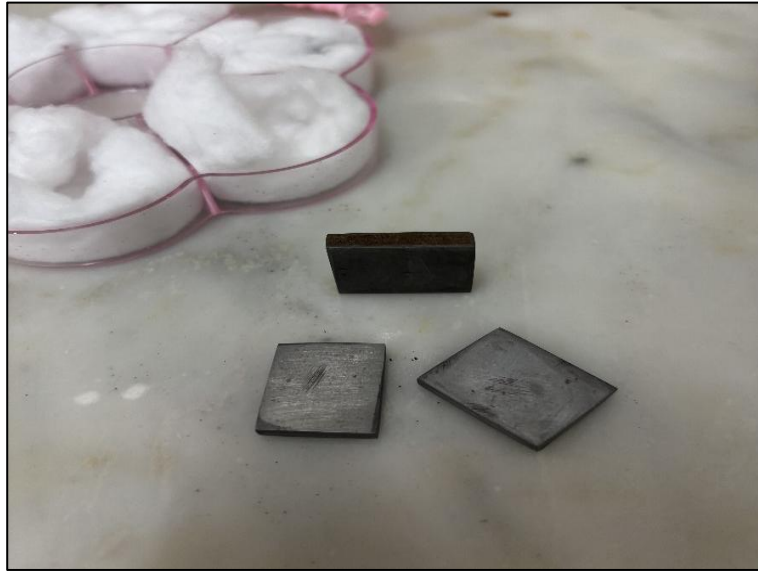
Figure III.14: L'échantillon après 5h dans la solution de HCl.
