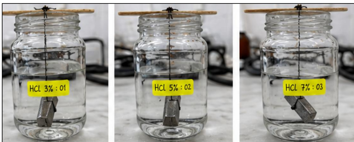
Figure III.13 : Immersion des échantillons sans peinture dans la solution de HCl.
