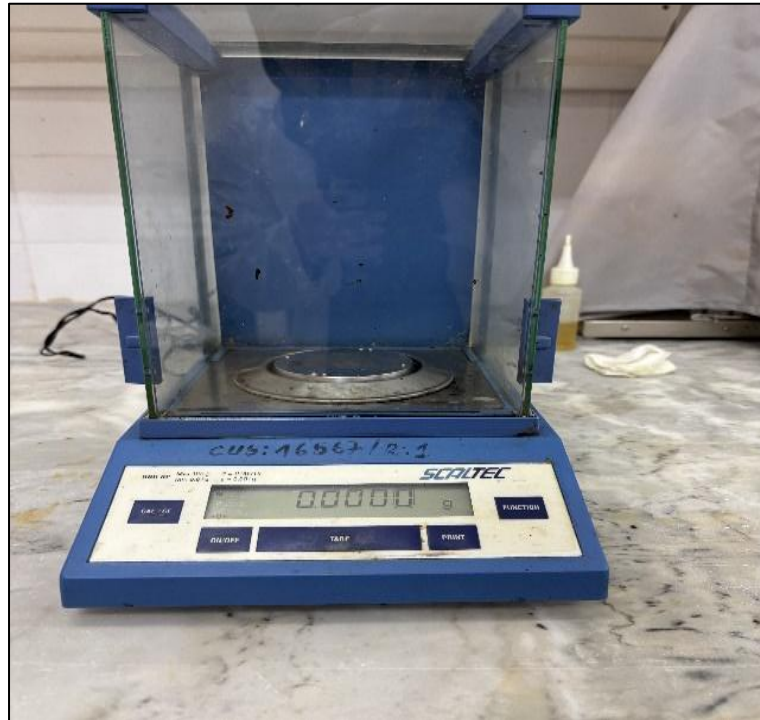
Figure III.3 : la balance électrique.
