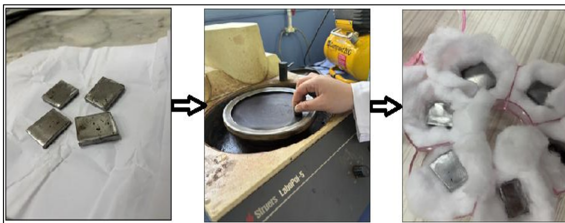
Figure III.2 : Polissage des échantillons de fer blanc.
