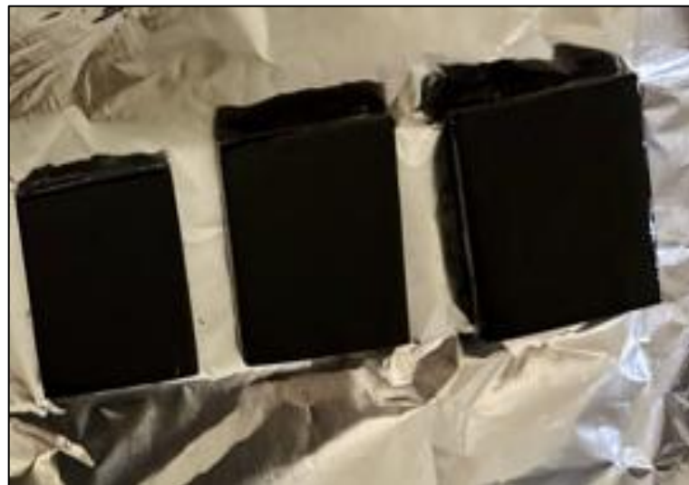
Figure III.21: L'échantillon après 5h dans la solution de H_2SO_4 .
