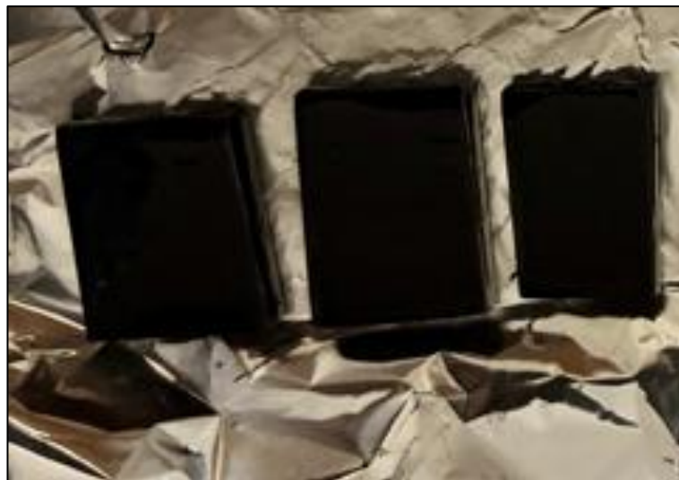
Figure III.23: L'échantillon après 5h dans la solution de NaCl.
