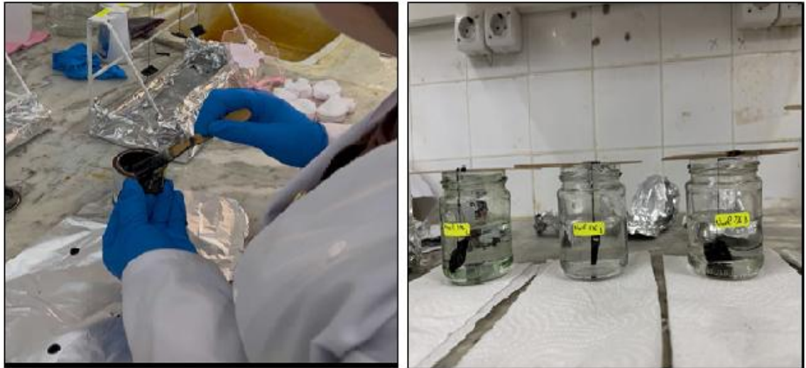
Figure III.18 : Immersion des échantillons avec couche de peinture dans la solution de NaCl.
