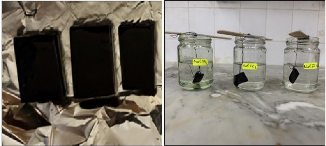
Figure III.22 : Immersion des échantillons avec deux couches de peinture dans la solution de NaCl.
