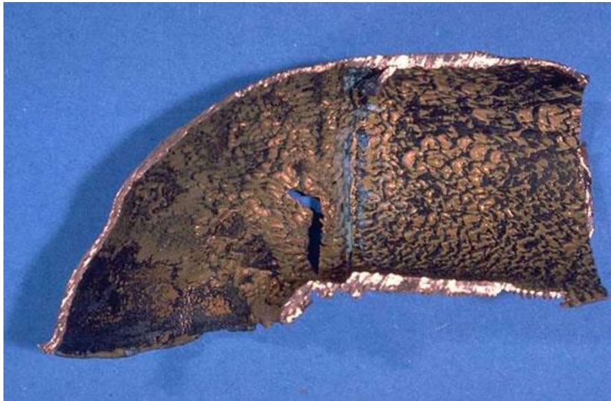
Figure I.11 : Le phénomène de corrosion-érosion [18].
