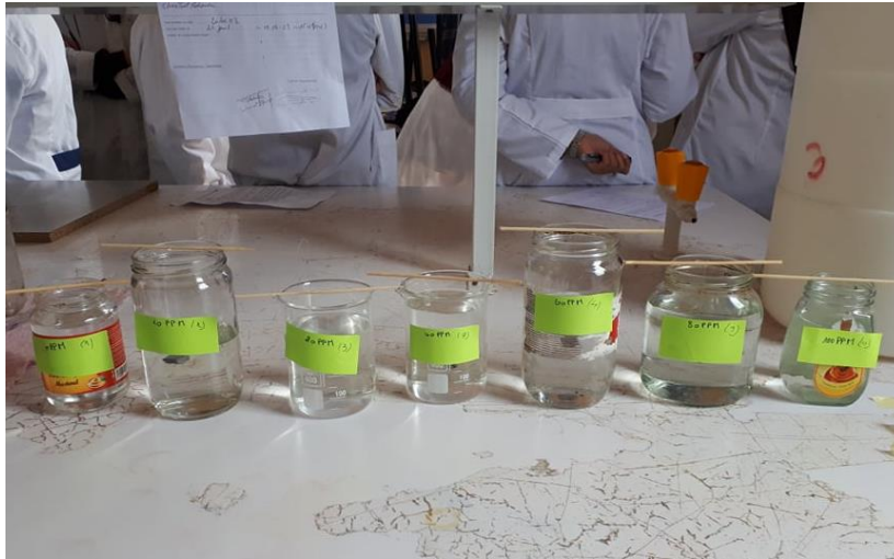
Figure III.14 : Echantillons d'acier dans une solution corrosive avec et sans inhibiteur.
