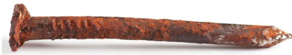
Figure I.16 : Corrosion atmosphérique d'un clou [28].
