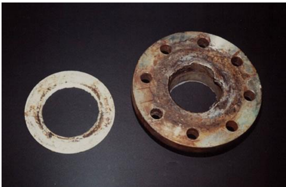
Figure I.10 : Corrosion caverneuse d'un acier allié sous un joint [16].
