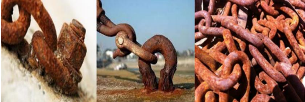
Figure I.5 : corrosion uniforme (généralisée) [8].
