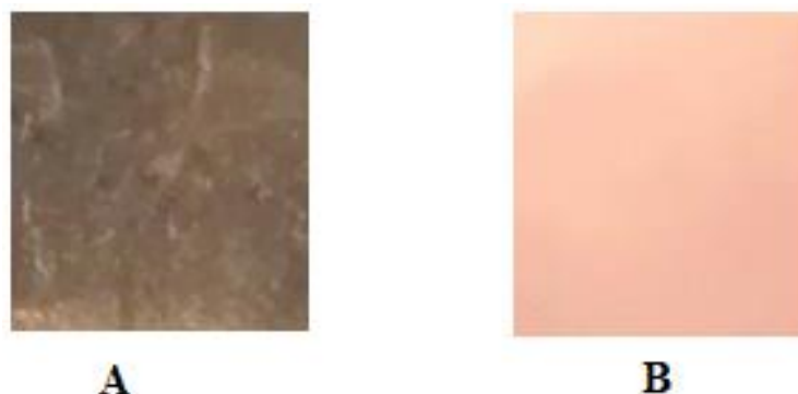
Figure II.8 : Plaque de cuivre avant polissage (A) et après le découpage polissage (B)
