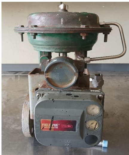
Figure 2.8 : Une Vanne Régulatrice
