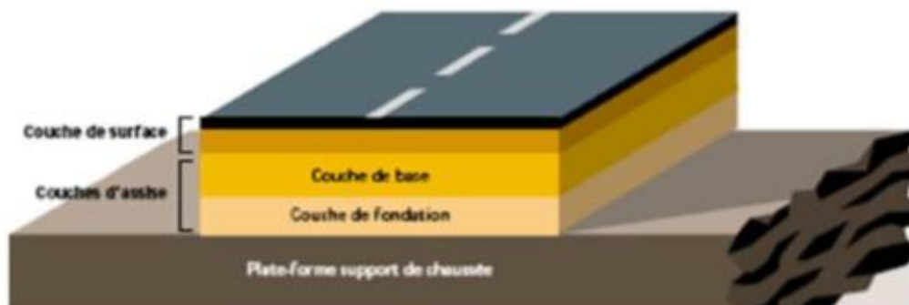
Figure IV. 1. Structure type d'une chaussée souple
