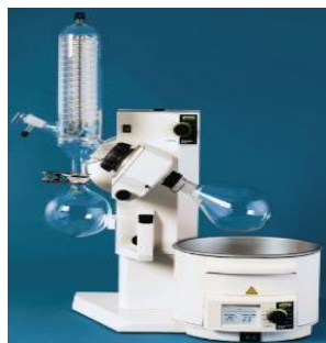
Evaporateurs sous vide
