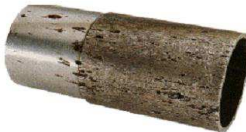
Figure I.4. Corrosion par piqûres d'un acier inoxydable [32]
