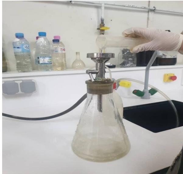
Figure III.8 : Filtration des échantillons à l'aide d'une pompe à vide
