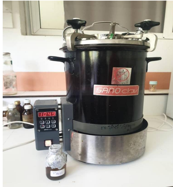
Figure III.16 : Autoclave pour stérilisation des milieux de culture
