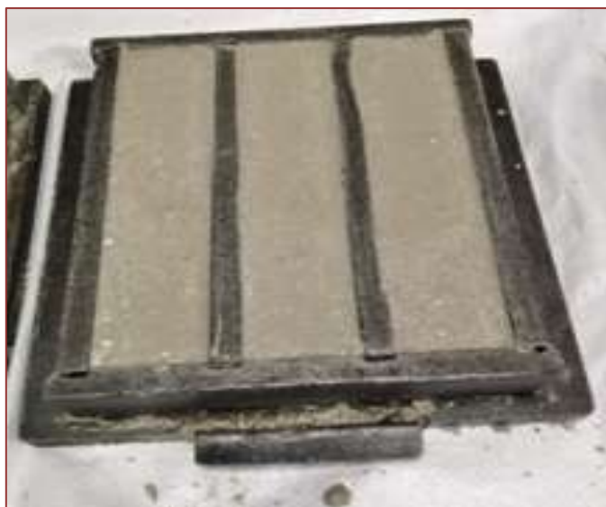
Figure III-9: Moule avant le décoffrage
