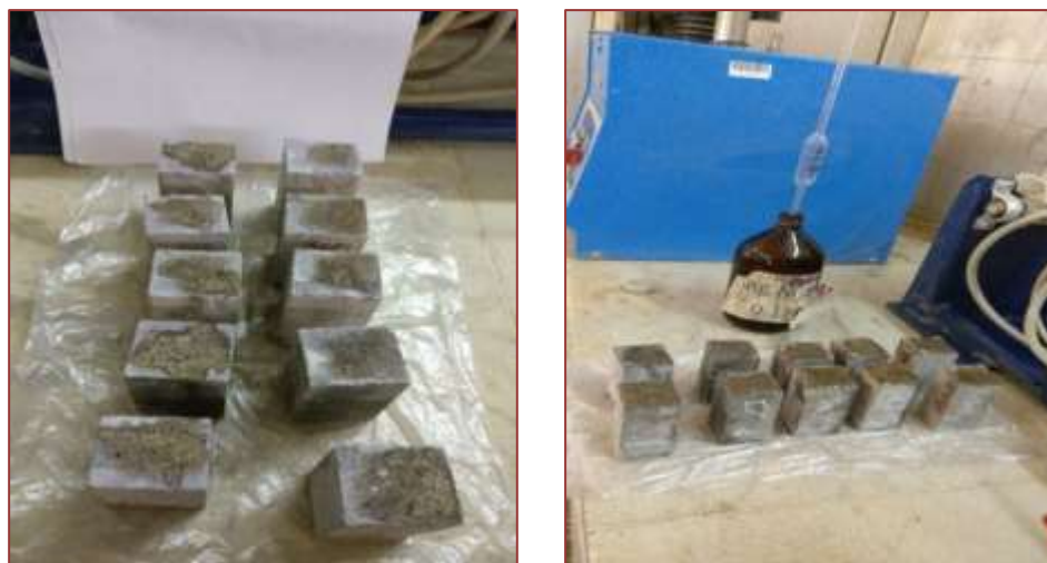
Figure III-19: Eprouvettes traités par le nitrate d'argent \text{AgNO}_3
