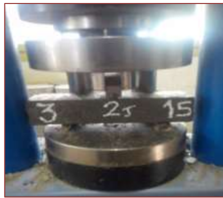
Figure III-15: Essai de traction par flexion
