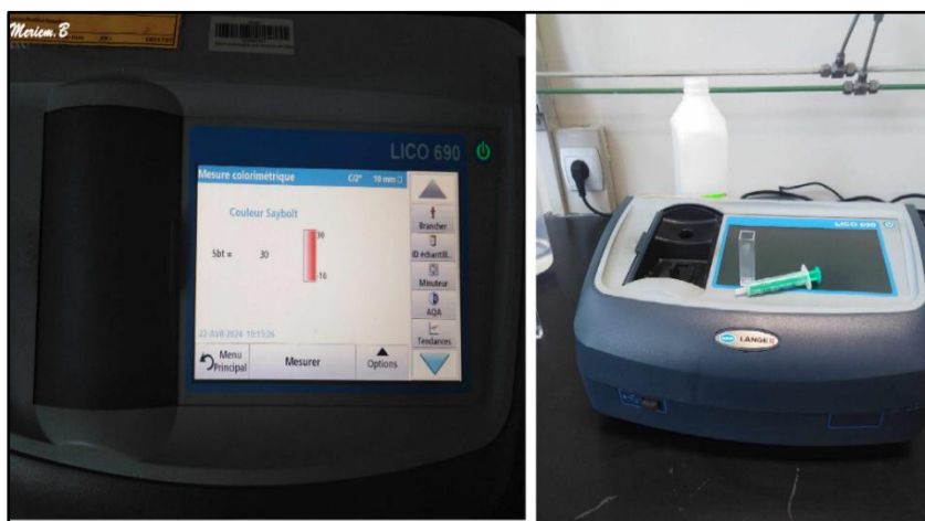
Figure IV.3. Colorimètre automatique (ASTM D1500 /ASTM D156).
