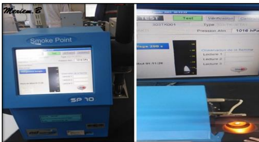
Figure IV.12. Appareillage de la détermination du Point de Fumée (ASTM D1322).
