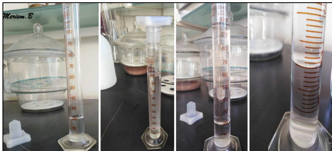
Figure V.1. Réaction à l'eau kérosène/Jet A1 (ASTM D 1094).
