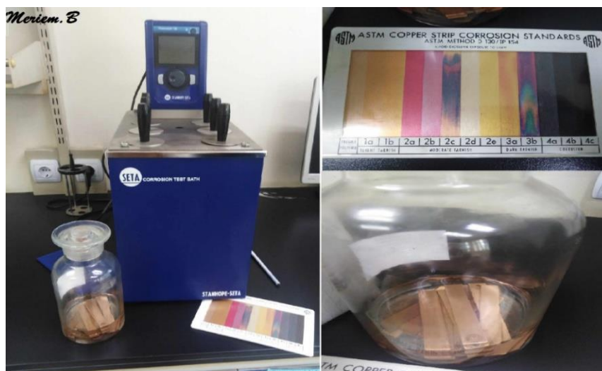
Figure IV.13. Appareillage de la corrosion à lame de cuivre (ASTM D130).
