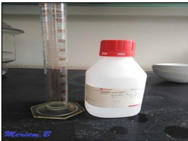
Figure IV.15. Réaction à l'eau (ASTM 1094).
