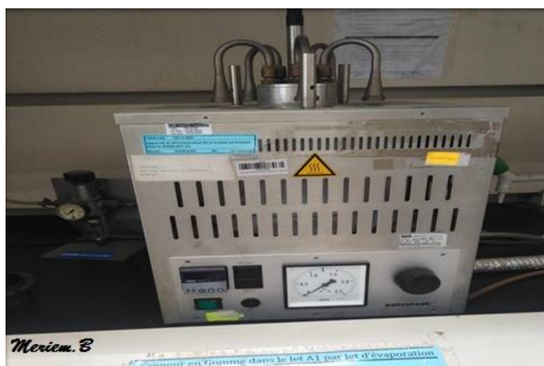
Figure IV.14. Appareillage de la détermination teneur en gommes actuelles (ASTM D381).
