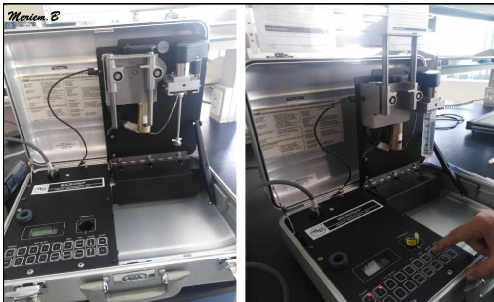
Figure IV.16. Appareillage de la MSEP carburant non additivé (ASTMD3948).
