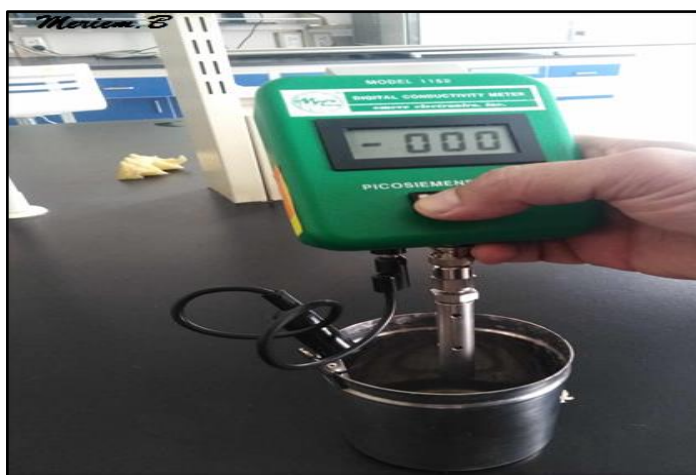
Figure IV.17. Détermination de la conductivité électrique (ASTM D2624).
