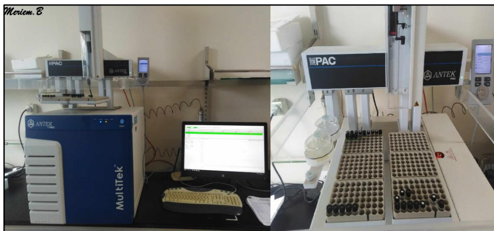
Figure IV.5. Appareillage détermination de la teneur en soufre total dans les produits pétroliers (méthode ultraviolet fluorescence) ASTM D5453.
