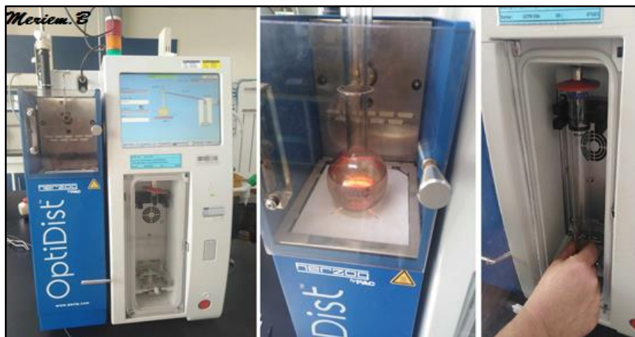
Figure IV.7. Appareillage de distillation atmosphérique automatique.
