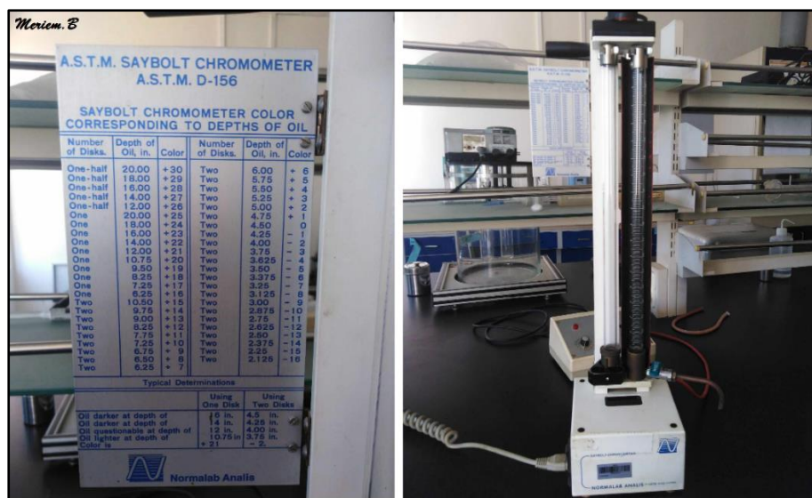
Figure IV.2. Chromomètre de Saybolt ASTM D156.
