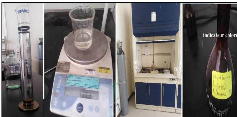
Figure IV.4. Appareillage de la détermination de l'acidité totale (ASTM D-3242).
