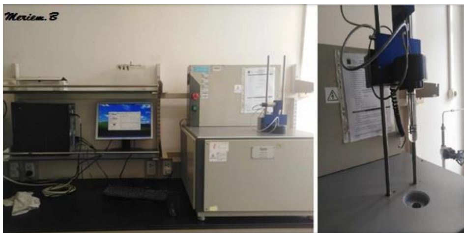
Figure VI.10. Appareillage de la détermination du point de congélation (ASTM D2386).
