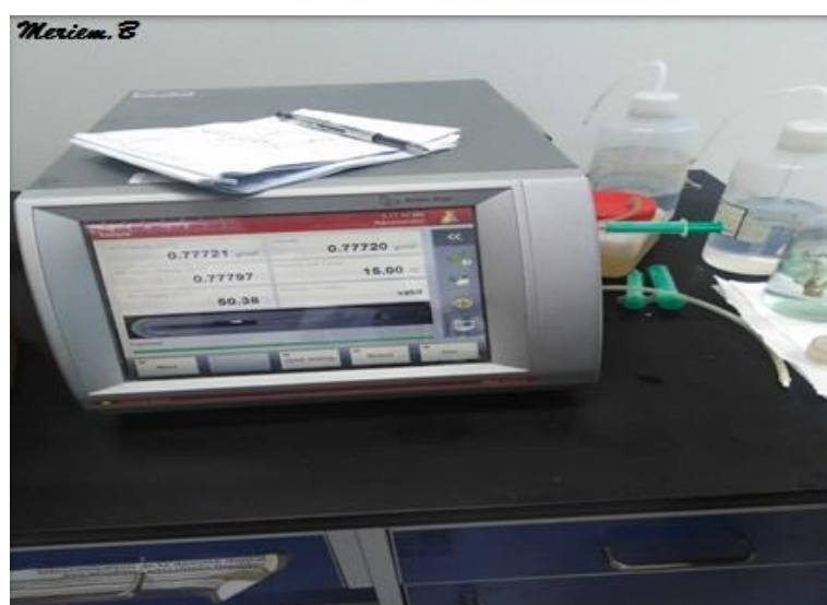
Figure IV.9. Densimètre automatique (ASTM D 4052-18).
