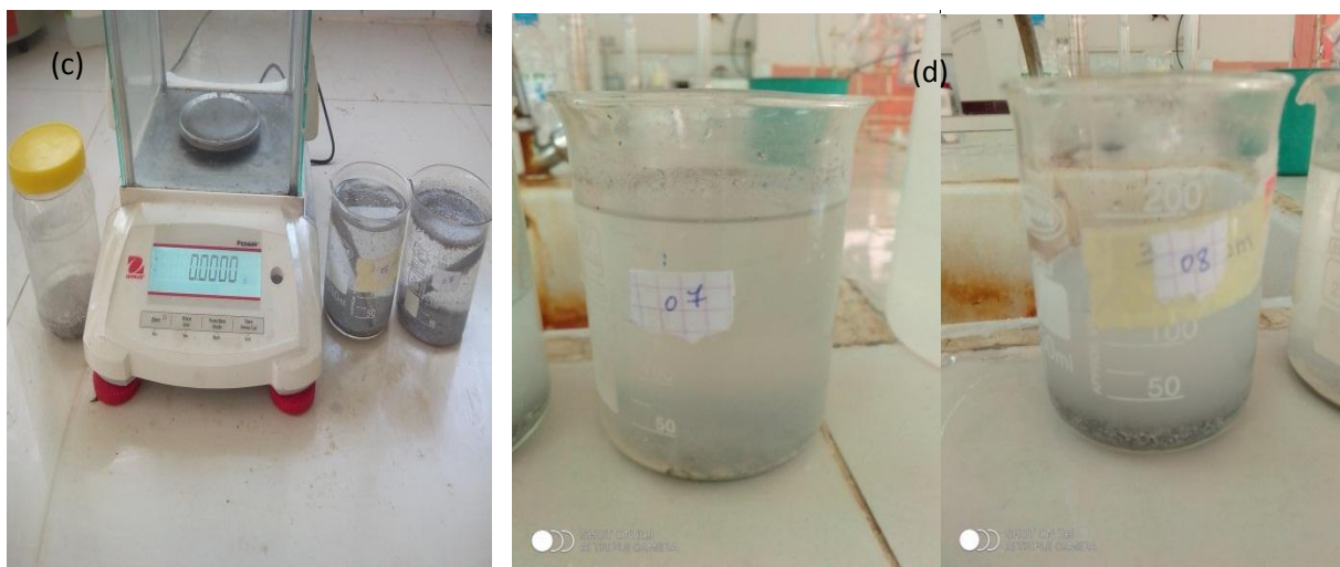
Fig. IV.3 : Les échantillons immergés dans les solutions (NaCl +Zn) avant (c)et après (d) avec addition de Zn après 168 heure d'immersion
