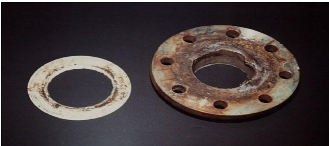
Fig. I.6: la corrosion caverneuse.
