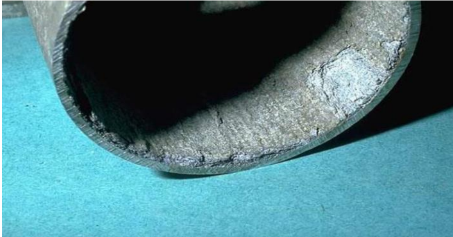
Fig.I.13: La corrosion sélective.
