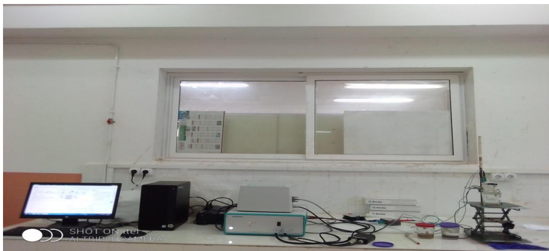
Fig.III.17: Montage de la chaîne de corrosion
