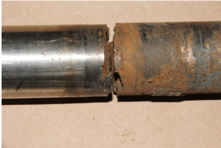
Fig.I.9 : La corrosion fatigue.
