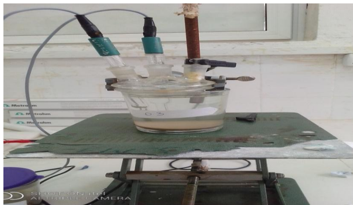
Fig.III.16: Montage expérimental de la cellule électrochimique
