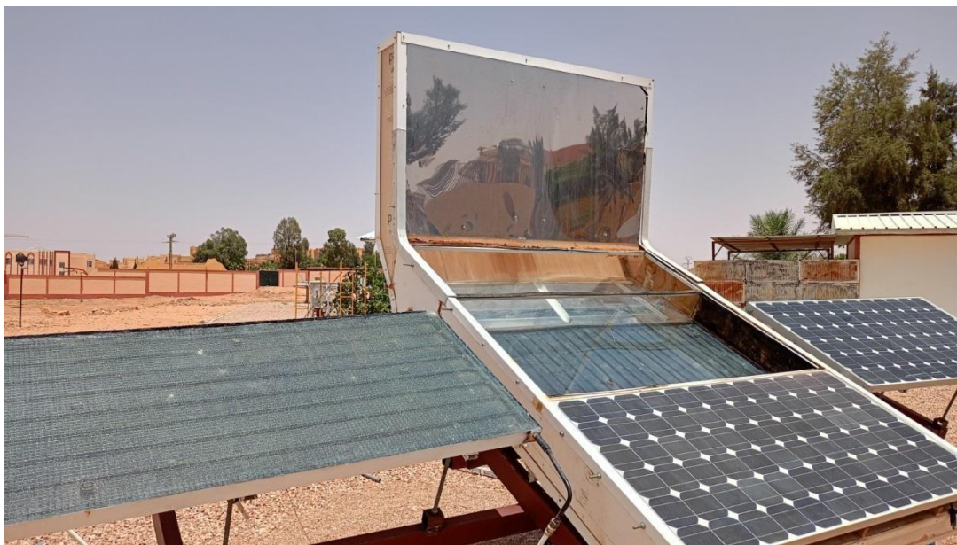
Figure II.1 : Image d'un système évaporateur solaire EPVT
