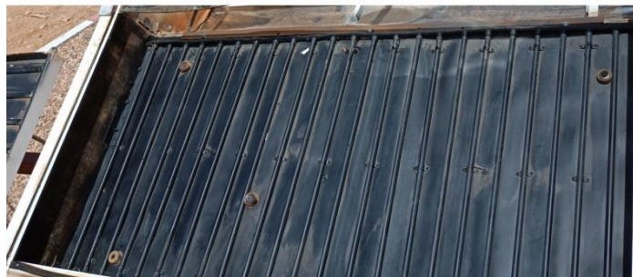
Figure II.4 : Image de l'échangeur thermique en cuivre
