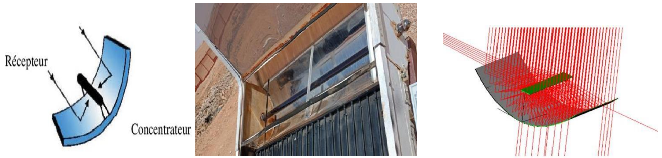
Figure II.6 : Concentrateur solaire Le cylindro-parabolique
