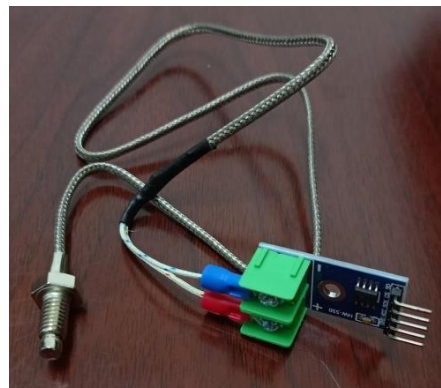
Figure II.12 : Image d'un thermocouple type K
