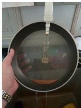
Figure.17 -Détermination de la fraction du sable par tamisage
