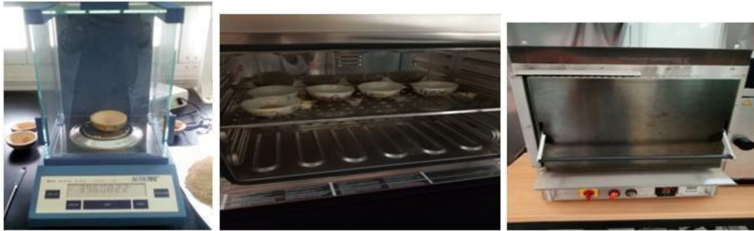
Figure.18- Détermination de la matière organique(méthode de laperteau feu)
