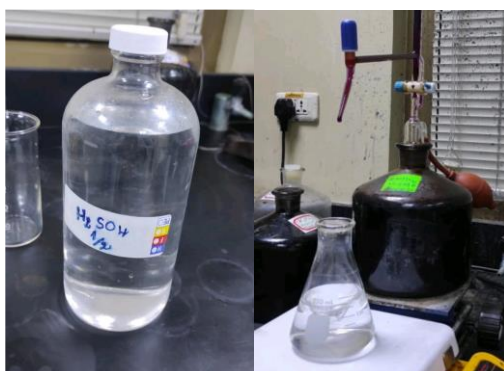
Figure 11 : Photographie du Dosage de Chlorures Cl- (photo originale).
