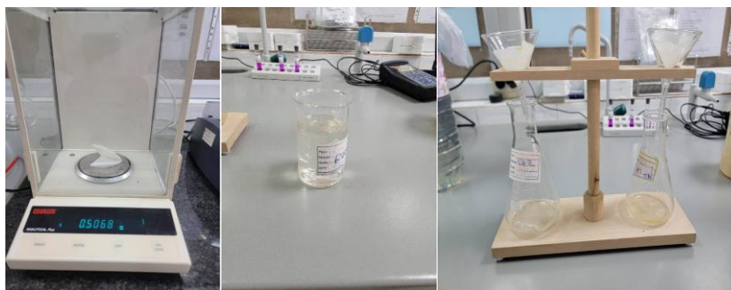
Figure 06 : Photographie de la méthode de mesure MES (photo originale)
