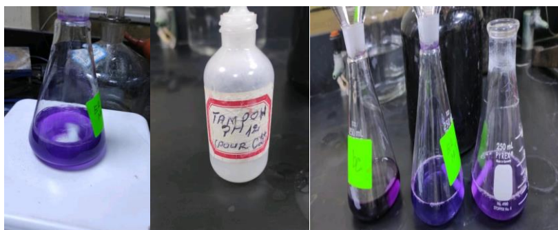
Figure 14 : Photographie du Dosage de TH \text{Ca}^{2+} (photo originale).
