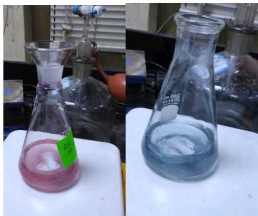
Figure 13 : Photographie du Dosage de Dureté total (THT) (photo originale).
