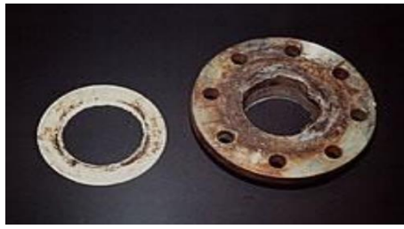
Figure. I.9 : La corrosion par crevasses d'un acier allié sous un joint.
