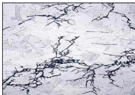
Figure .I.10: La corrosion inter-granulaire.
