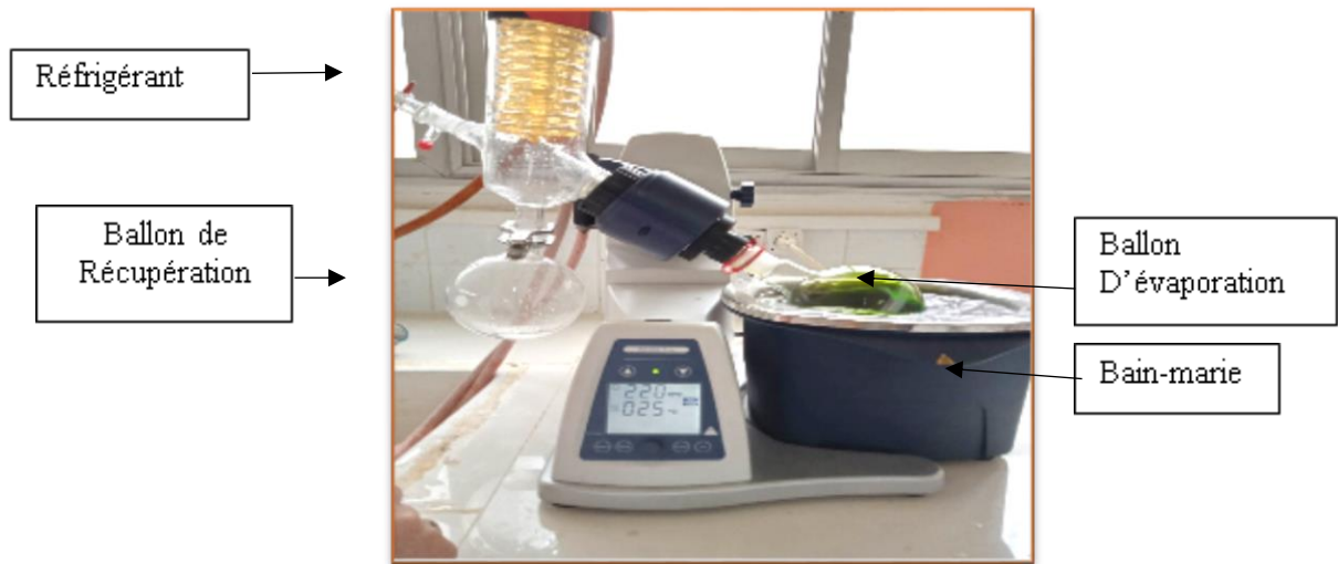
Figure n °14: L'évaporateur rotatif RE-100 PRO (Originale, 2023).
