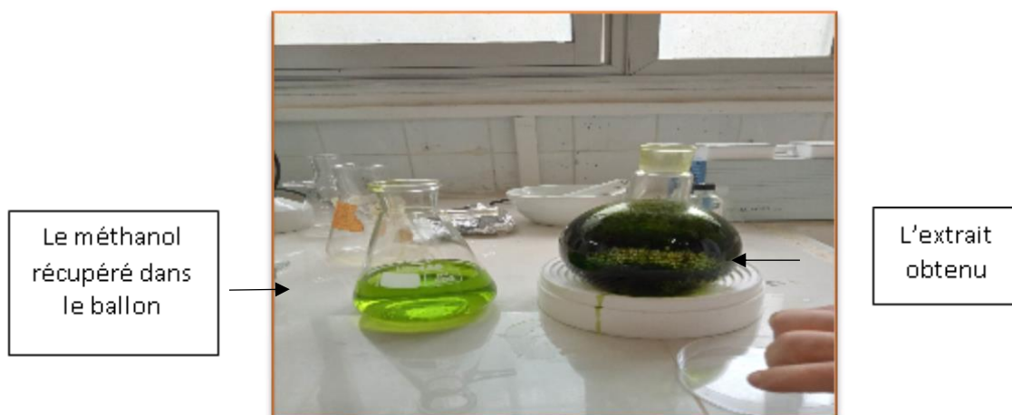
Figure n °15 : L'extrait obtenu après élimination du solvant pour le calcul du rendement d'extraction (Originale, 2023).
