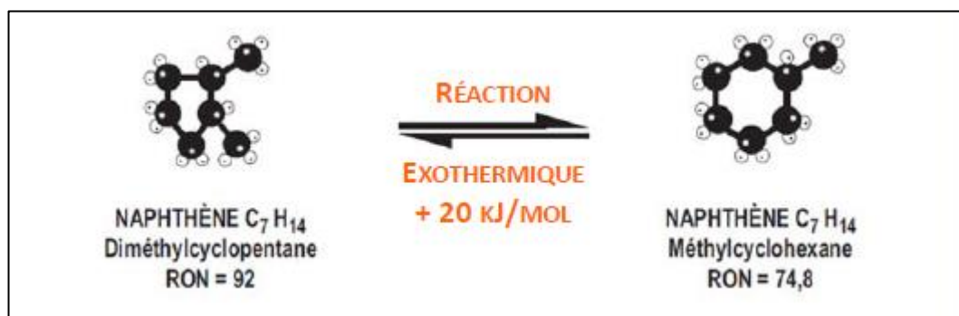
Figure n° I-4 : Exemple de transformation des alkylcyclopentanes en alkylcyclohexanes.[5]
