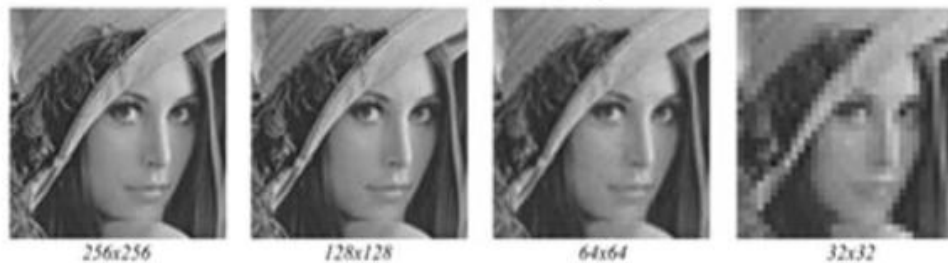
Figure I.3. Echantillonnage d'une image.
