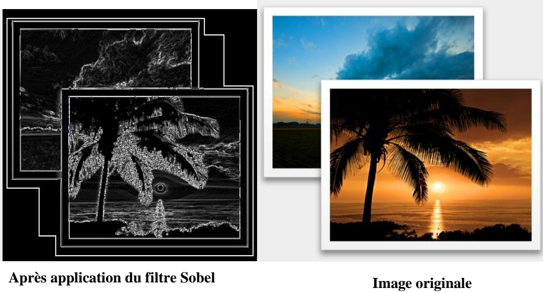
Figure III.14. Exemple de l'application d'un filtre Sobel
