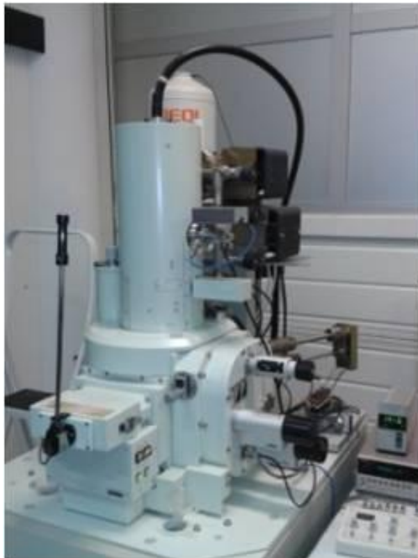
Figure II.7 : Microscope électronique à balayage utilisé dans la caractérisation des couches minces CdZnS.
