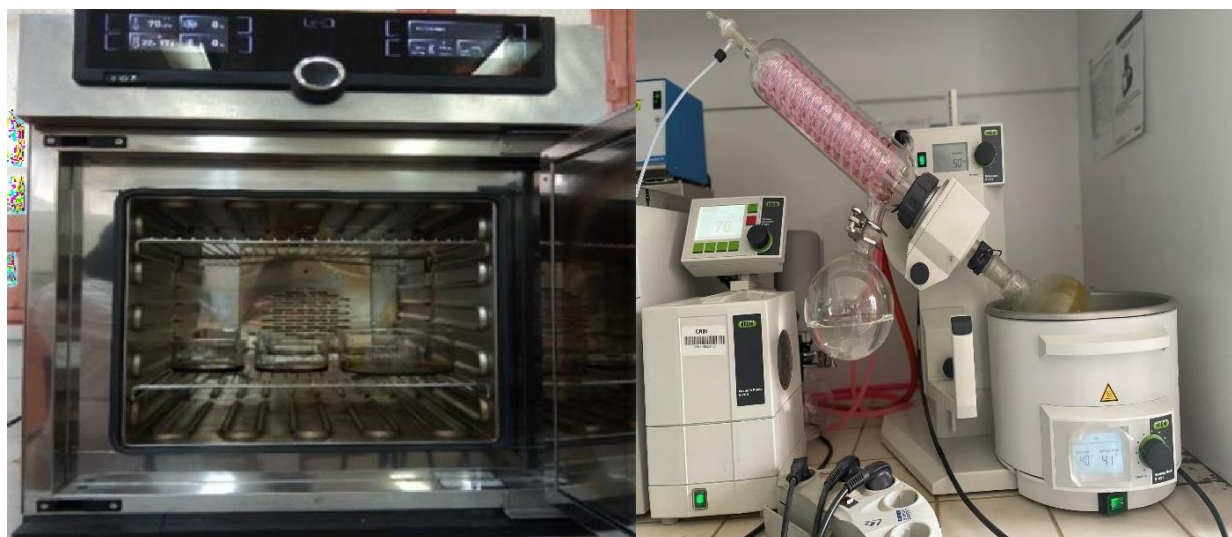
Figure.III.4. Distillation du solvant par Rotavape
