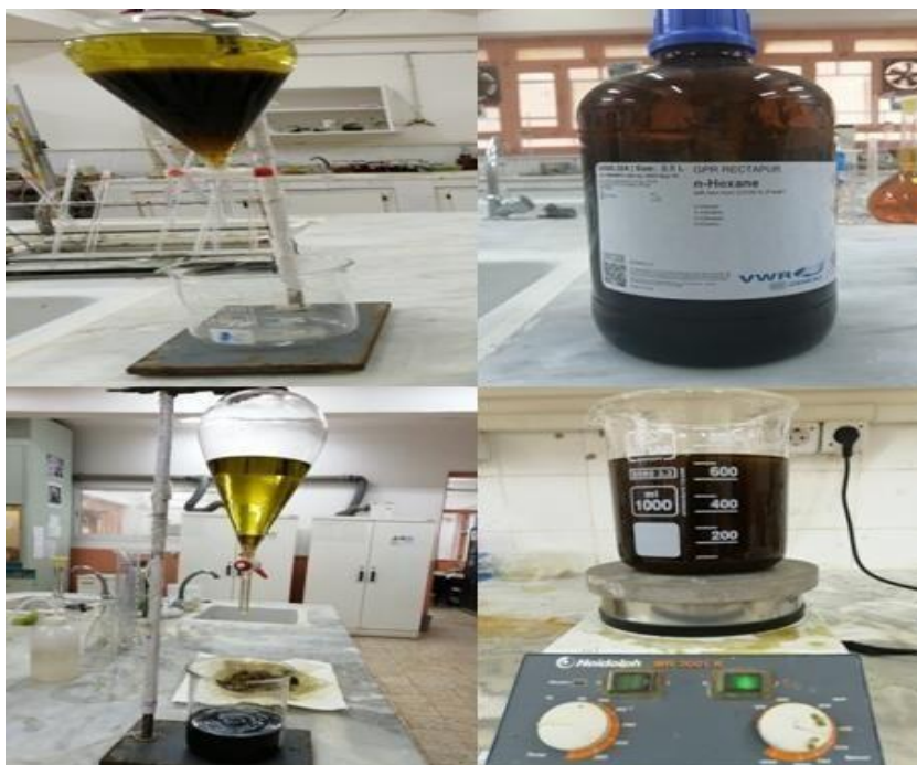
Figure III.3 Décantation du mélange hexane/filtrat
