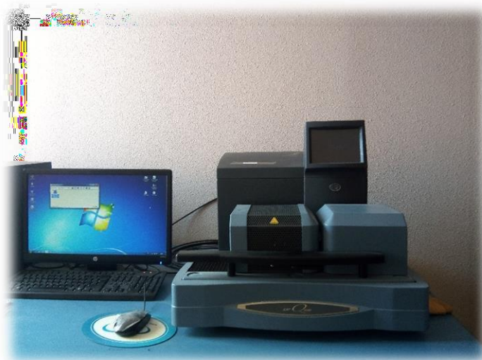
Figure IV.10. L'appareil ATG de type SDTQ600
