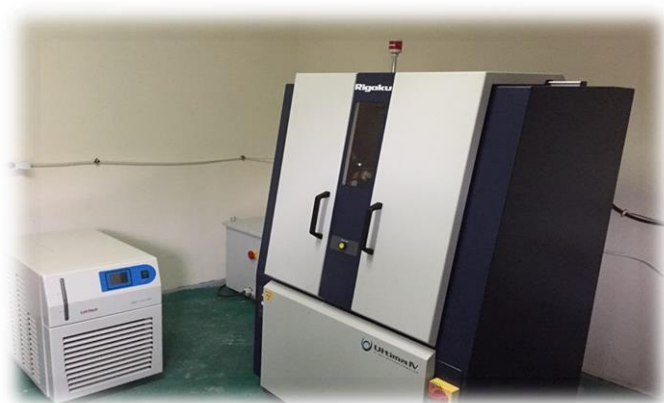
Figure IV.7. L'appareil de DRX de type Rigaku Ultima IV
