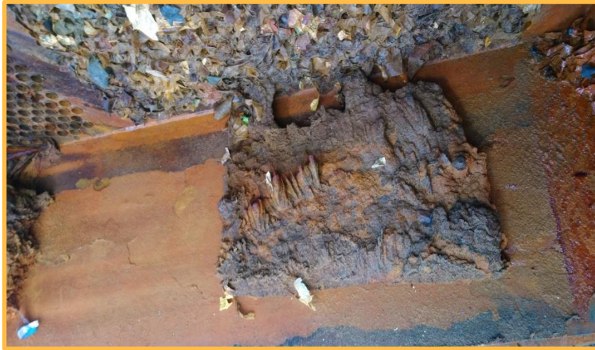
Figure IV.16 : Irrégularité de la surface de l'anode et consommation plus de 50 % de son épaisseur.
