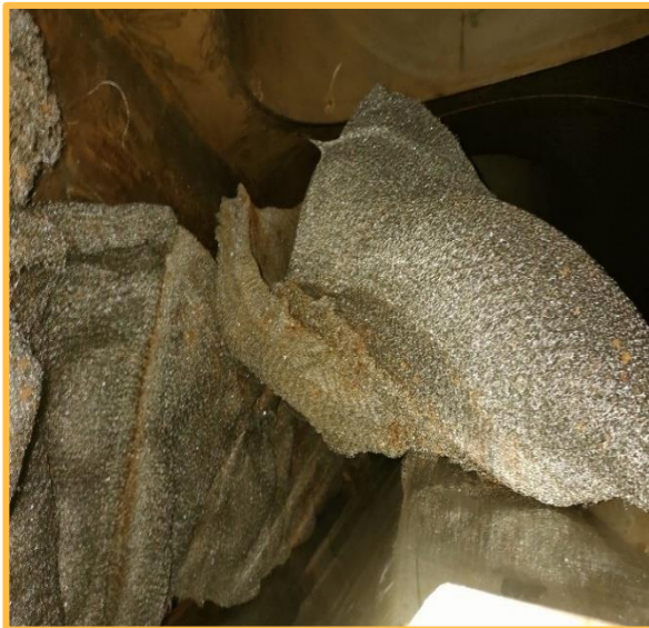
Figure IV.12 : Détachement et endommagement des démisters.
