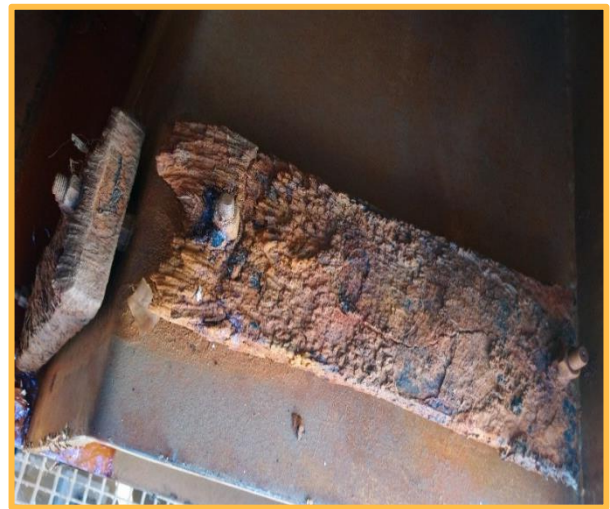
Figure IV.17 : Désintégration des anodes et corrosion des boulons d'encrage.
