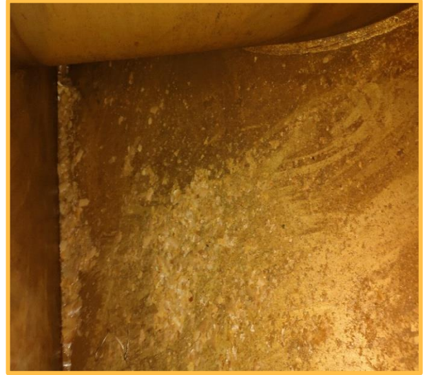
Figure IV.11: Encrassement des démisters et du fond de la 6 ème cellule.
