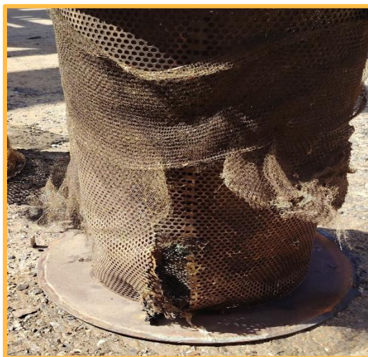
Figure IV.14 : Corrosion, encrassement et déchirure des cartouches des filtres.
