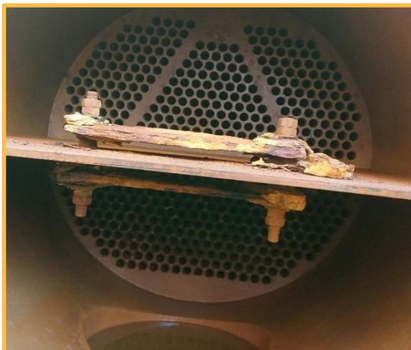
Figure IV.17 : Désintégration des anodes et corrosion des boulons d'encrage.
