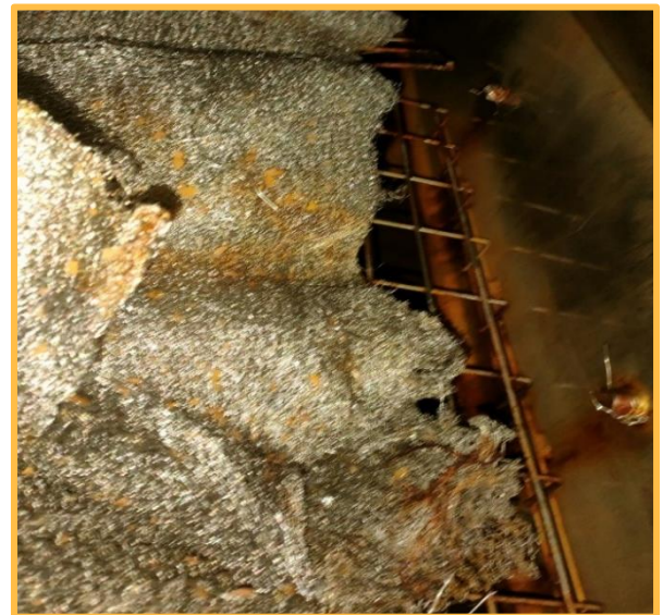
Figure IV.12 : Détachement et endommagement des démisters.
