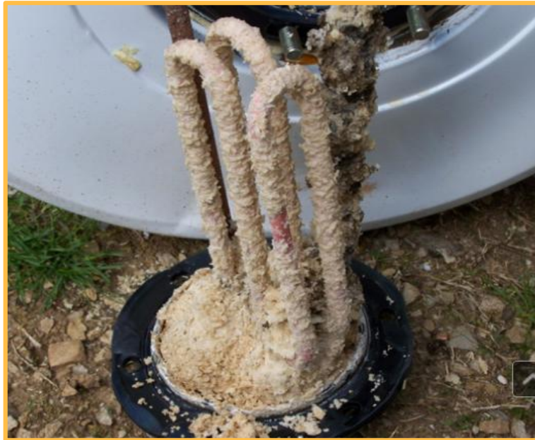
Figure II.1 : Résistance de chauffe-eau électrique entartrée.
