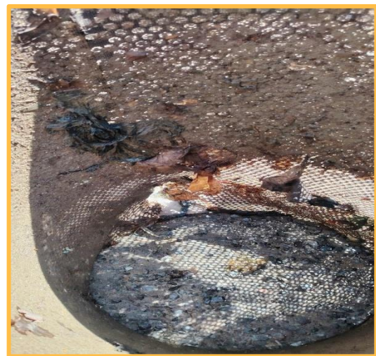
Figure IV.14 : Corrosion, encrassement et déchirure des cartouches des filtres.
