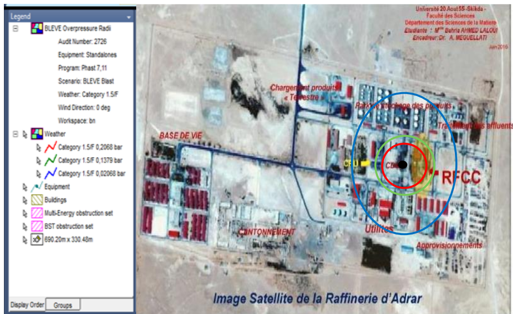
Figure V.10 : représente Les zones touchées par la propagation de phénomène BLEVE La figure ci-dessus représente les zones touchées par la propagation de BLEVE leur développement après quelque seconde.
