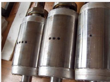
Figure III. 8: Rotors avec des barres cassées.
