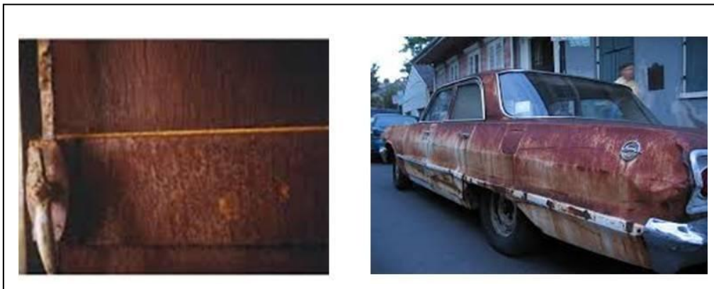
Figure I.4. : Corrosion générale (rouille) d'une pièce en acier [11].
