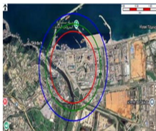
Figure V. 11: Cartographie des zones d'impact thermique de la boule de feu (Fireball).
