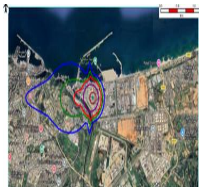
Figure V. 14: Empreinte cartographique au sol et franges de concentration du nuage inflammable avant ignition.
