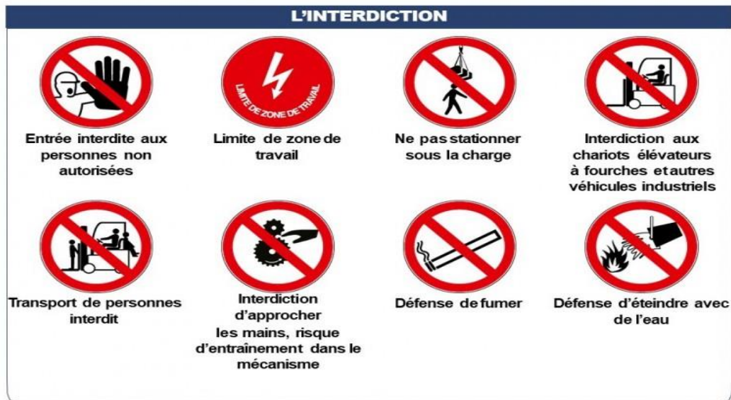
Figure I. 3: Signaux d'interdiction liés aux risques mécaniques [10].
