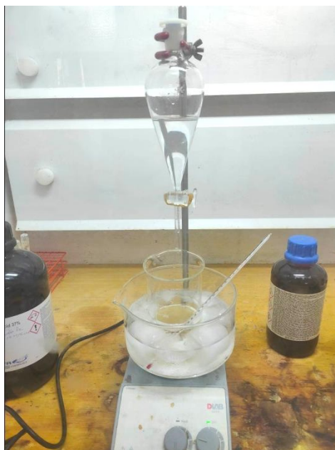
Figure IV.2 : Montage de synthèse de polyaniline.
