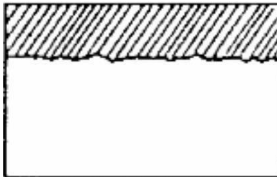
Figure I.1 : Schéma de corrosion uniforme [9].
