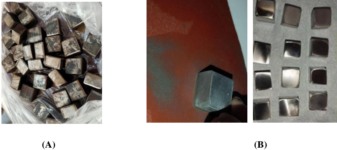
Figure III.5 : L'acier (A) avant et (B) après le polissage.
