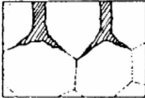
Figure I.4: Schéma de corrosion inter granulaire [9].
