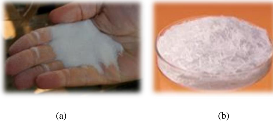
Figure III.4 : (a) Particules (microbilles) de verre ; (b) fibres de verre courtes [3].
