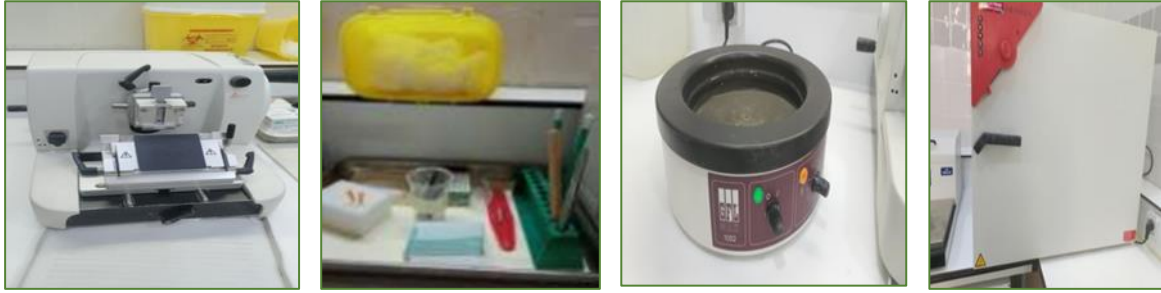
Figure 20 : matériels de la coupe A-microtome, B- lames, C- bain marie, D- l'étuve 140°C. (Photos originale, 2025).
