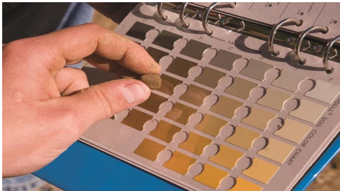
Figure 05 : La couleur d'un sol est codée par comparaison avec le nuancier de Munsell (Munsell Soil Color Chart).
