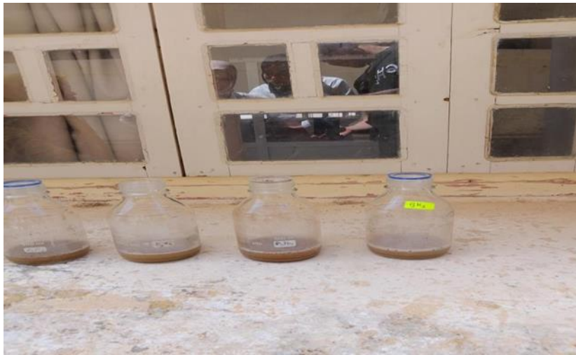
Figure 23 : Effervescence du sol après ajout d'eau oxygéné
