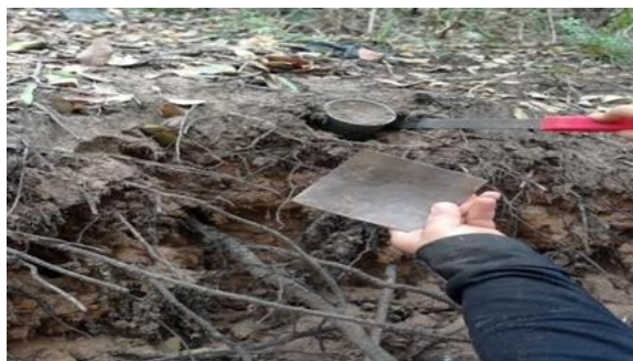
Figure 22 : Prélèvement de densité apparente
