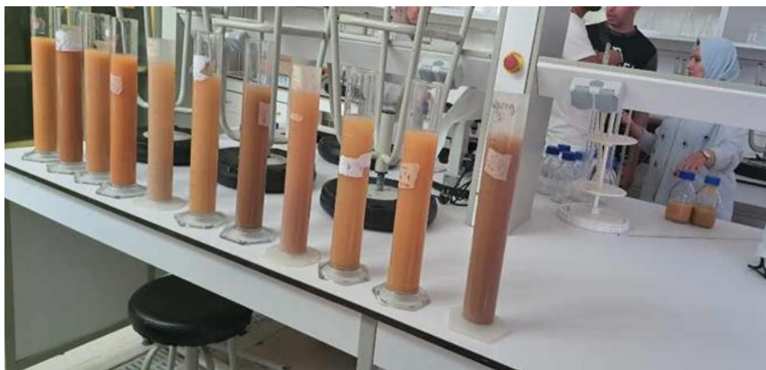
Figure 21 : colonnes de sédimentation
