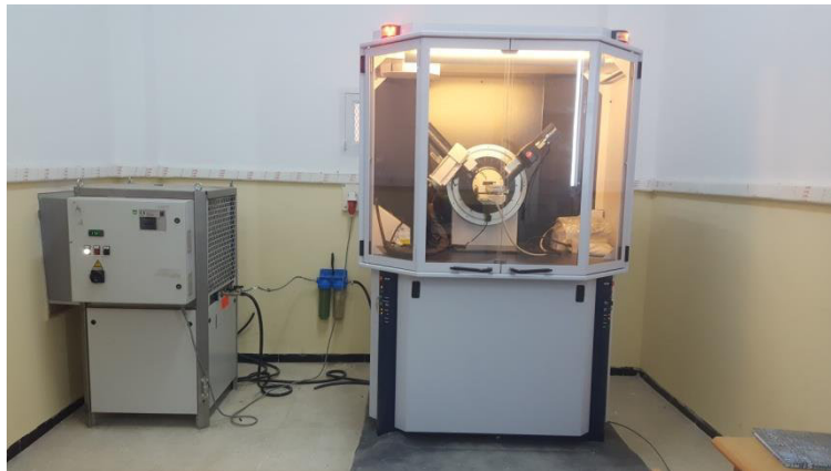
Figure III.4. Photo du diffractomètre utilisé pour détermination de la structure de nos échantillons.
