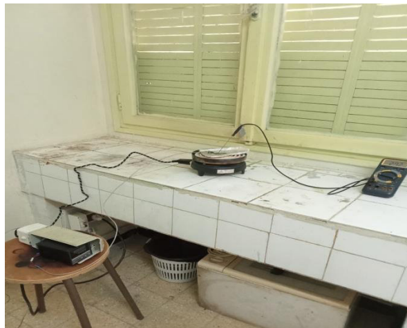
Figure III.2. Montage réel du spray pyrolyse monté au laboratoire LRPCSI de l'université de Skikda
