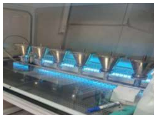
Les rampes de filtration.
