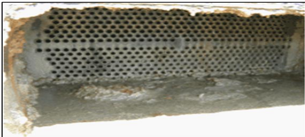
Figure II.18 : Dépôts de slime bactérien, hydrocarbures et oxydes métalliques dans un échangeur de chaleur eau hydrocarbures (raffinerie de pétrole) [14]
