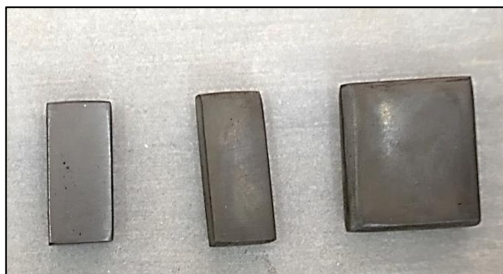
Figure III.26 : Échantillons encrassés après le nettoyage.
