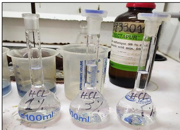
Figure III.19 : Solutions d'HCL de différentes concentrations.
