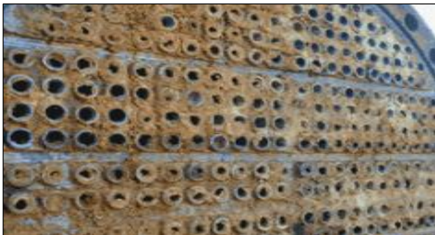
Figure I.10 : Encrassement d'un échangeur [13]
