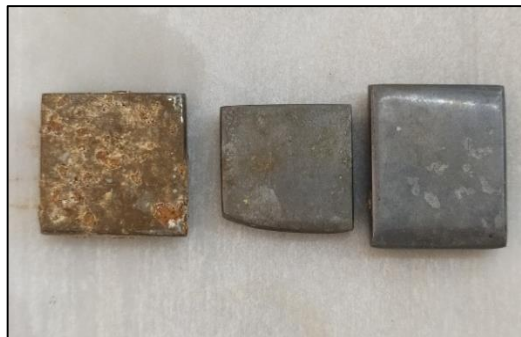
Figure III.23 : Échantillons entartés après le nettoyage.
