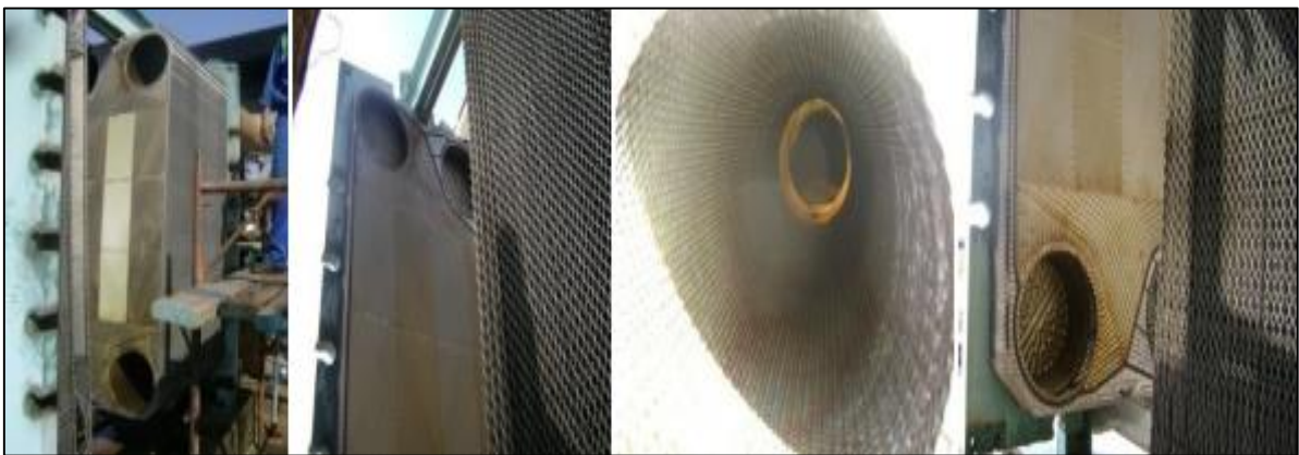
Figure II.3 : Exemple des différentes parties d'un échangeur à plaques (CP/2K, Sonatrach Skikda) [9]
