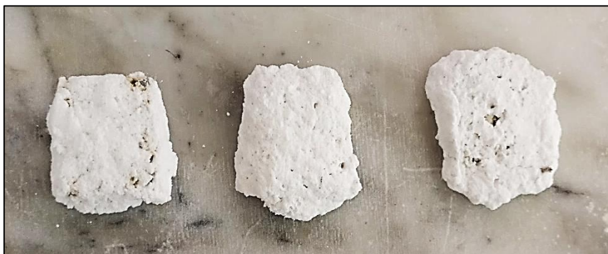
Figure III.13 : Echantillons après séchage (entartrés).
