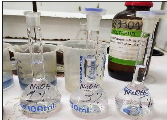
Figure III.18 : Solutions de NaOH de différentes concentrations.
