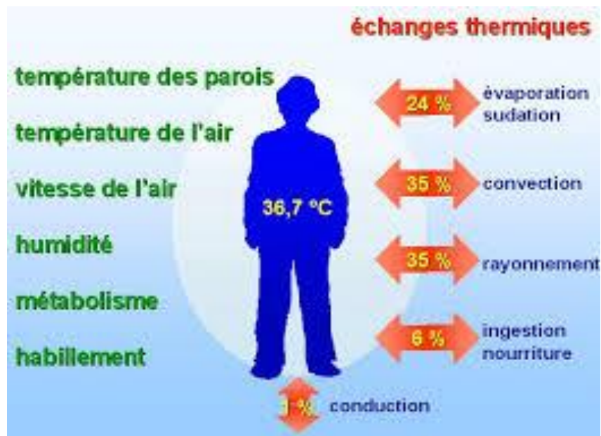
Figure 05 : les six paramètres de confort thermique
