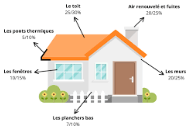
Figure 08 :les points des déperditions
