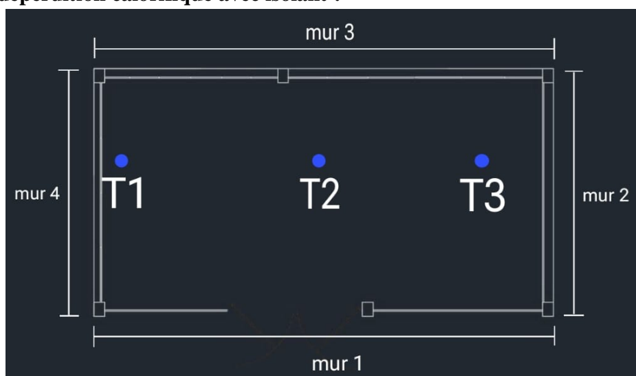
Figure 72 : Lieu de mesure de la température
