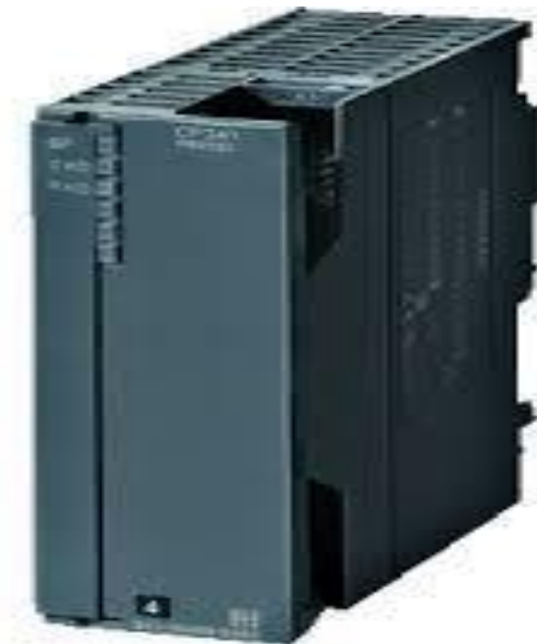
Figure 1-21 : Connexion point à point CP 341 [11]
