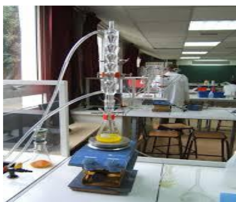
Figure IV. 2 : Montage pour recristallisation
